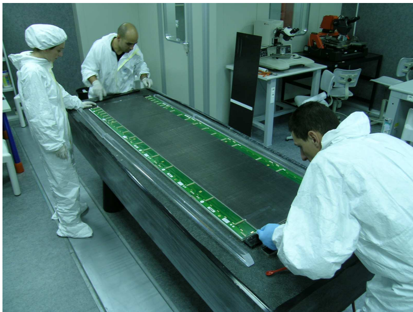
FIGURE 4.8 – Latte des stations 3, 4 et 5 du système de trajectographie.
