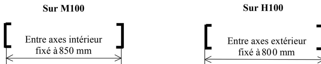
Figure 19 : Différences de fixation sur M100 et H100
