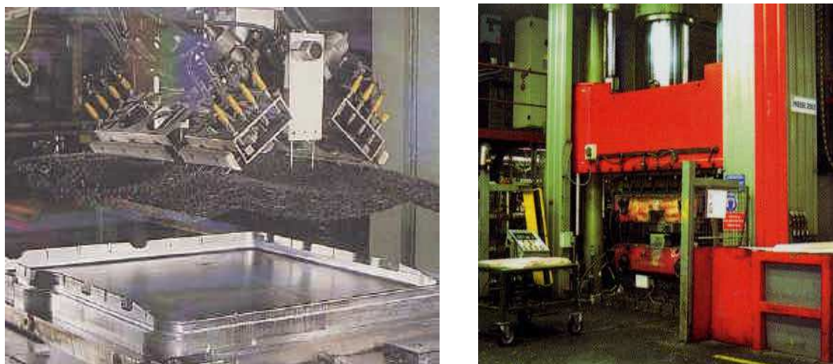
Figure 6 : Moule et presse du procédé SMC (source Inoplast et [Alliance 97])
