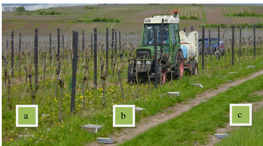
Figure II.19. Emplacement des 3 plaques inox permettant de mesurer le dépôt au sol à (a) 0, (b) 1 et (c) 3 m de la parcelle sous le vent lors du traitement H1.
