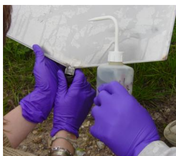
Figure II.20. Récupération des gouttelettes de pesticides sur la plaque de dépôt par rinçage à l'eau (traitement H1).
