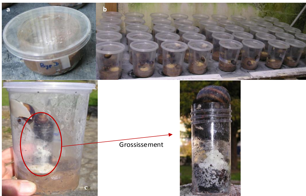
Figure II.13. Dispositifs d'exposition par le sol et la nourriture pour l'évaluation des effets des pesticides sur l'ensemble du cycle de vie de l'escargot durant la 2 nd e expérience (Chapitre 3, section III.3.2) : (a) développement embryonnaire; (b) croissance; (c) reproduction.
