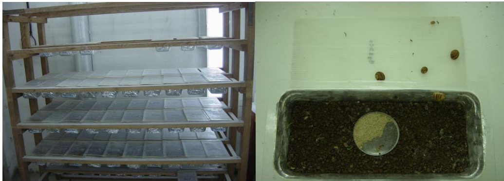
Figure II.12. Système d'exposition des escargots par le sol et la nourriture pour la mesure des effets à long terme durant la 1 ère expérience (Chapitre 3, section III.3.1).
