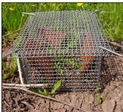
Figure II.14. Microcosme utilisé pour l'évaluation des effets des pesticides appliqués sur une parcelle de vigne sur l'escargot (Chapitre 4, section III.4). Dimensions : cage : 25x25x15 cm ; couvercle : 30x30 cm scellé par 4 piquets. Le maillage est de 1x1 cm.
