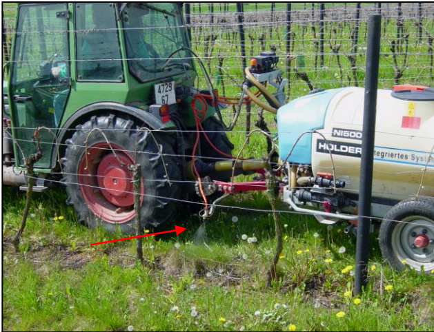
Figure II.17. Désherbage sous le rang et traitement des rejets de la vigne au glyphosate par jet projeté (traitement H1).
