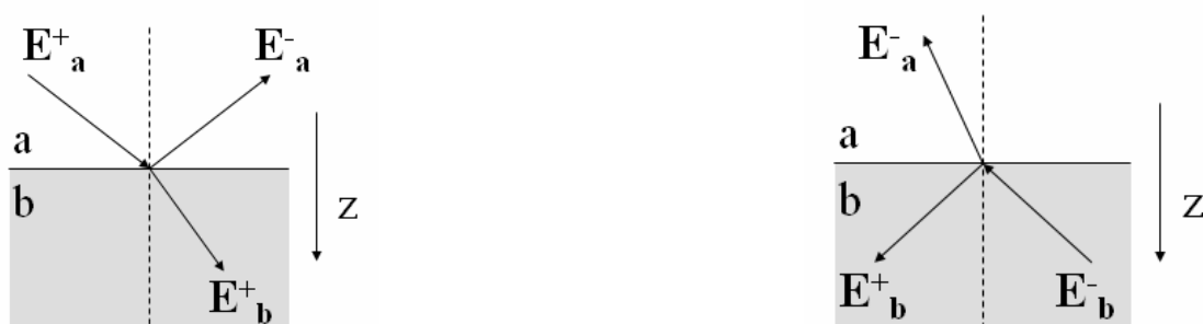
Fig. 2.6 : Réflexion et transmission au niveau de l'interface entre deux milieux d'indices différents, (a) le faisceau vient du milieu a, (b) le faisceau lumineux vient du milieu b.
