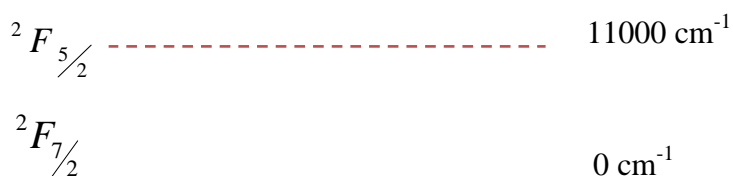
Fig. I.12 niveaux d'énergies de l'ion Ytterbium isolé.
