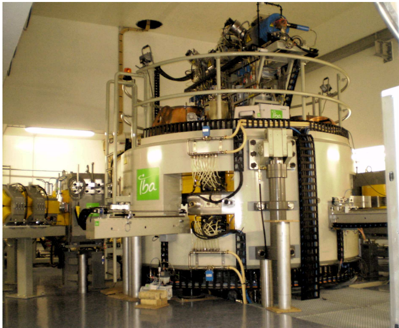
FIGURE 1.7 - Photo du cyclotron ARRONAX après installation. Ses dimensions sont de 3.6 mètres de haut sur un diamètre de 4 mètres pour un poids total avoisinant les 140 tonnes.
