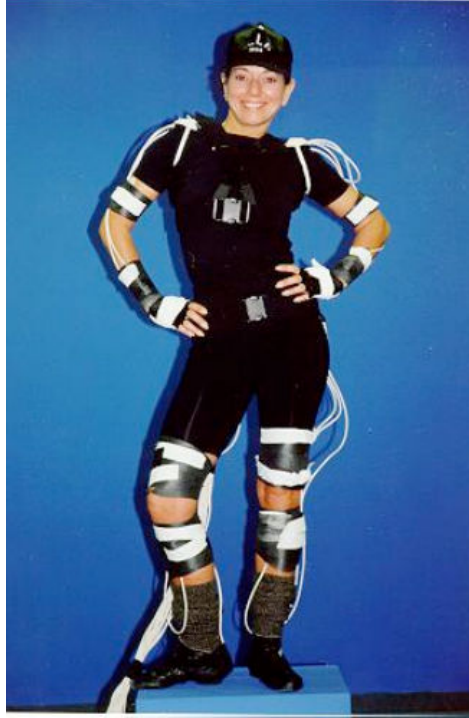
Figure 3.2 – Un exemple de placement de capteurs issu d'un système de capture de mouvements électromagnétique (image tirée de [Bodenheimer et al., 1997]).
