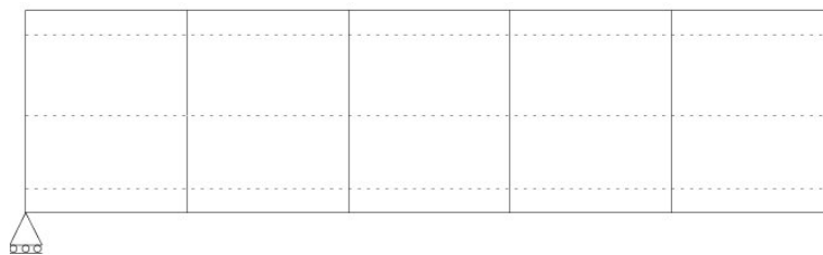
FIGURE 3.4 – Maillage de la demi-poutre sandwich
