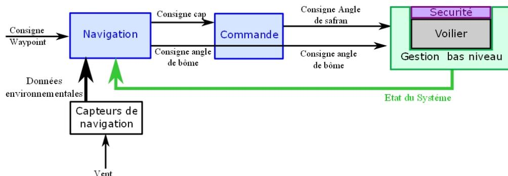
FIGURE 4.30 – Modules logiciels du voilier à échelle réduite
