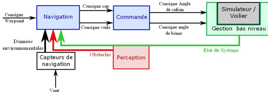
FIGURE 5.1 – Architecture générale du système de contrôle
