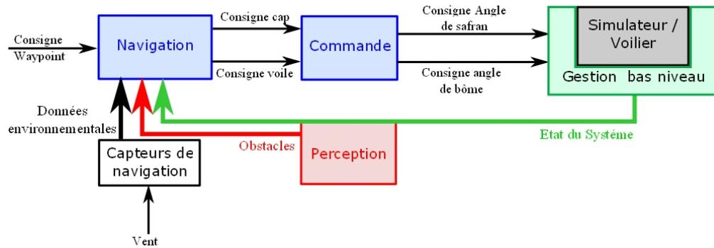
FIGURE 4.18 – Modules logiciels du voilier *Asarome*
