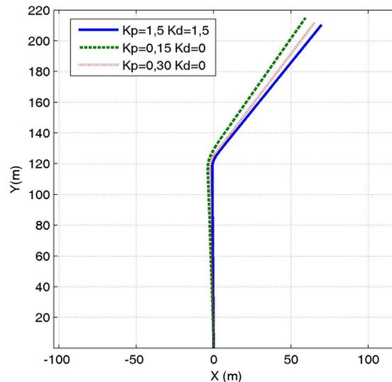
FIGURE 5.4 – Asservissement de cap : influence des gains du régulateur PID
