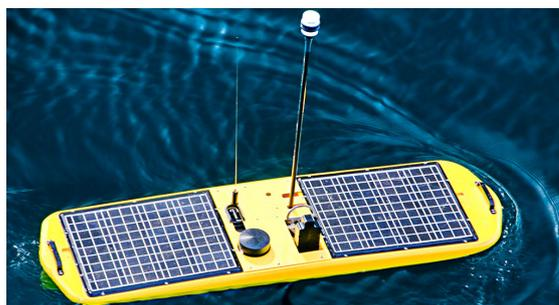
FIGURE 2.25 – *Wave Glider* (Liquid Robotics, États Unis)
