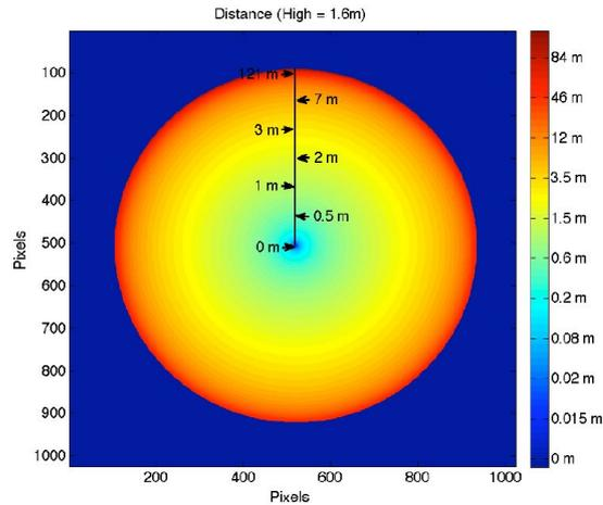
FIGURE 4.19 – Estimation des distances pour chaque pixel dans l'image
