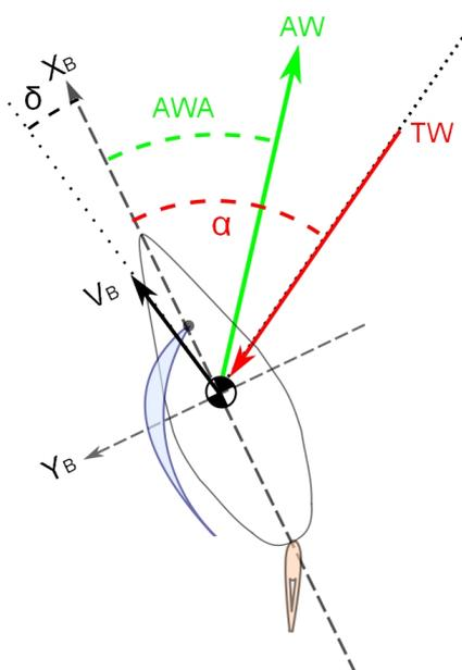
FIGURE 3.2 – Vent apparent, cap et route
