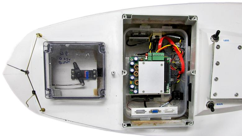
FIGURE 4.24 – Pont arrière du bateau et accès étanches
