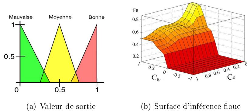
FIGURE 5.17 – Variable linguistique de sortie et surface d'inférence
