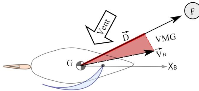
FIGURE 5.11 – Illustration de la *VMG* : projection de vitesse du voilier sur la route directe menant au point visé
