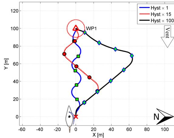
FIGURE 5.20 – Influence du potentiel d'hystérésis sur la navigation
