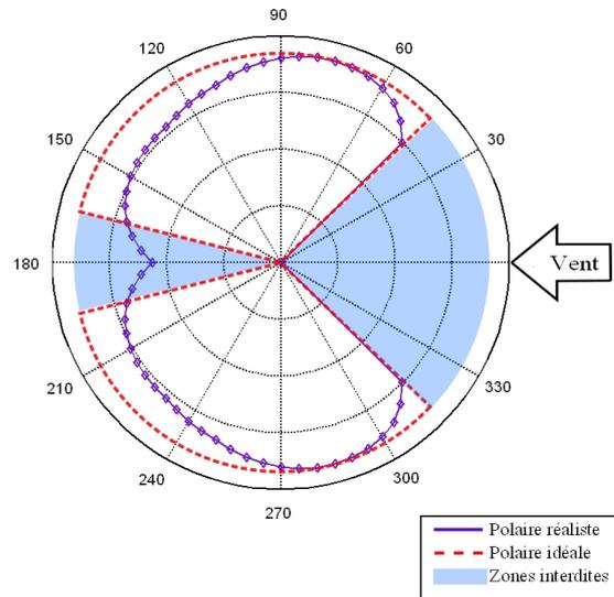
FIGURE 6.4 – No-go zone des polaires de vitesse idéale et réelle
