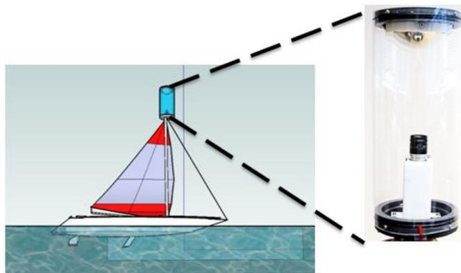
FIGURE 4.5 – Capteur catadioptrique en haut du mât
