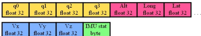
FIGURE 4.9 – Exemple de trame de données Xsens
