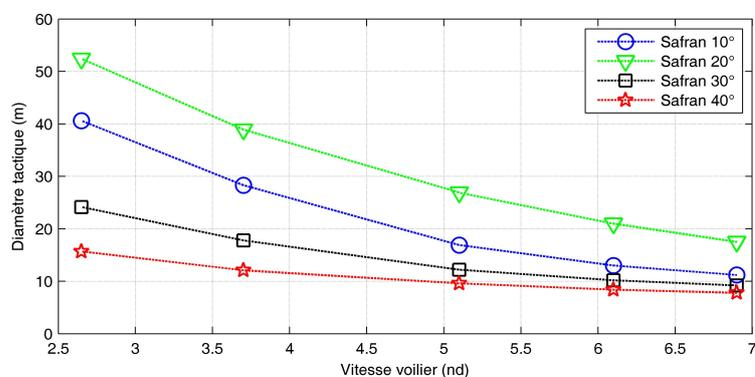
FIGURE 3.19 – Comportement en virage : diamètre tactique
