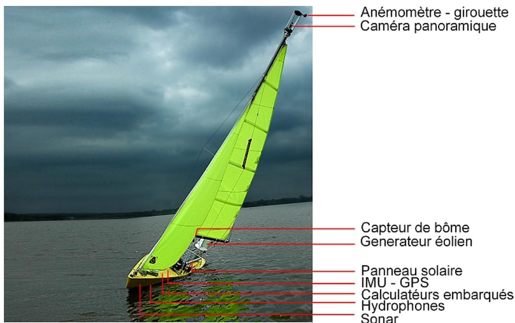
FIGURE 4.1 – Localisation des capteurs sur le voilier *Asarome*
