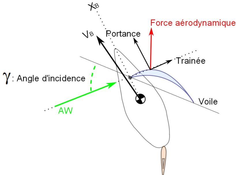
FIGURE 3.3 – Force aérodynamique s'exerçant sur la voile
