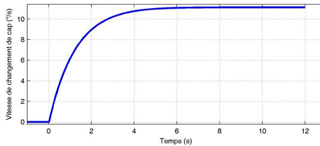
FIGURE 3.21 – Réponse en vitesse de changement de cap  $\dot{\psi}$  à un échelon d'angle de safran de  $20^\circ$  (vitesse voilier : 5,1 nd)
