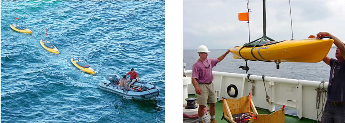
FIGURE 2.6 – SCOUT : trois plates-formes en coopération (a) et avec des AUV sur le pont d'un navire lors d'une campagne de test de coopération ASV-AUV (MIT, États-Unis)
