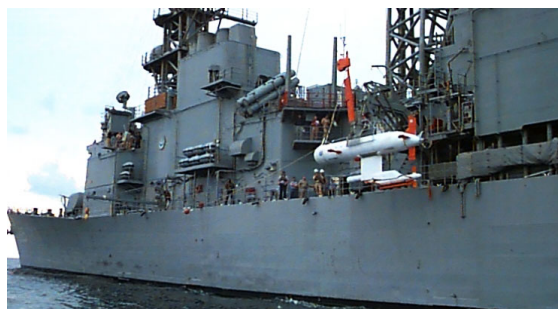
FIGURE 2.15 – RMOP (Remote Minehunting Operational Prototype) en déploiement dans le golfe persique
