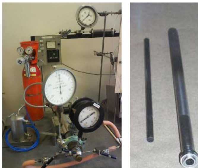
Figure II-3 Photographie d'un dispositif (à gauche), et d'un tube autoclave avec une barre inox de remplissage de volume mort (à droite).
