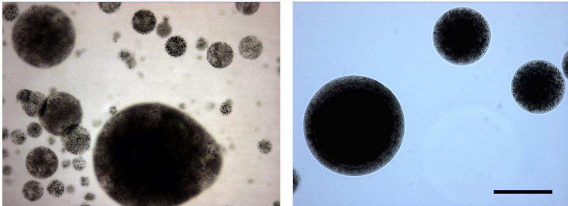
**Légende :** A gauche les billes sont photographiées avant tamisage, à droite après tamisage à travers des filtres de 300 et 400 microns. La barre en bas à droite correspond à 300 microns (grossissement initial 50X). La coloration noire est due à l'encre de Chine. Le tamisage a permis d'obtenir des billes de taille relativement uniforme en éliminant les billes de très grosse et de très petite taille.
