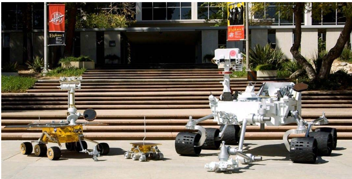
Figure 2.2 : Comparaison d'un robot MER (Opportunity et Spirit, à gauche) avec le robot Pathfinder (Sojourner, au centre) et le robot MSL (Curiosity, à droite). (Crédits : JPL).
