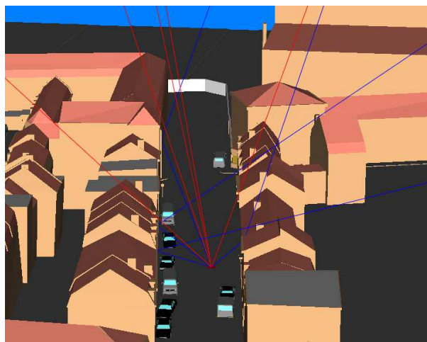
FIGURE 3.1 – Simulation de la réception des signaux d'une constellation GPS en environnement urbain.
