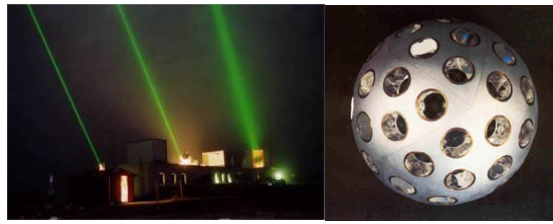
Fig. 1.2 - Les 3 stations de télémétrie laser de Grasse en France (station laser ultra mobile, laser satellite fixe et laser Lune), et satellite Starlette lancé par le CNES en 1975.
