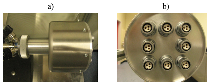
FIGURE 8.3 – a) Photographie de la tête de la canne de mesure vue de côté. b) Photographie des connecteurs Fischer.
