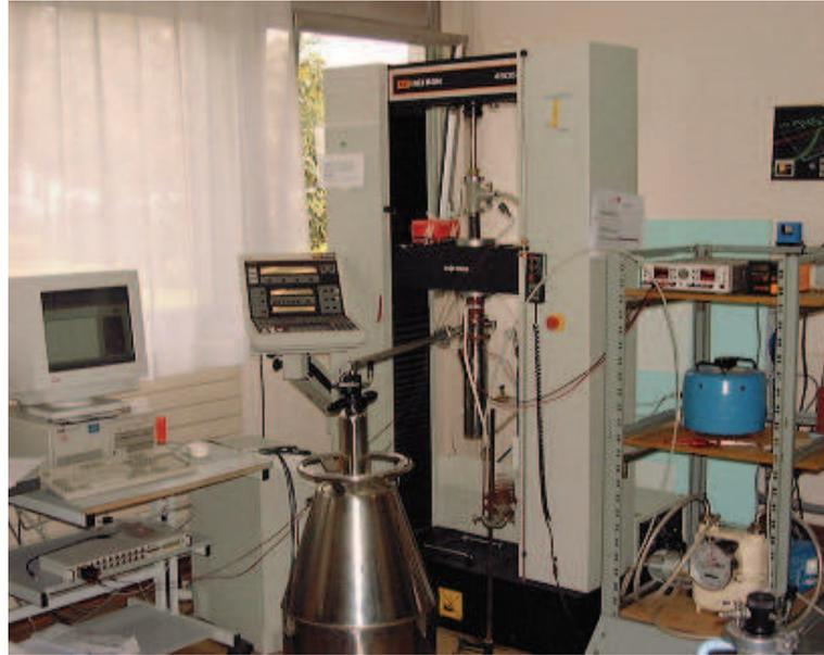
Figure D. 4 : Ensemble du montage de traction a froid
