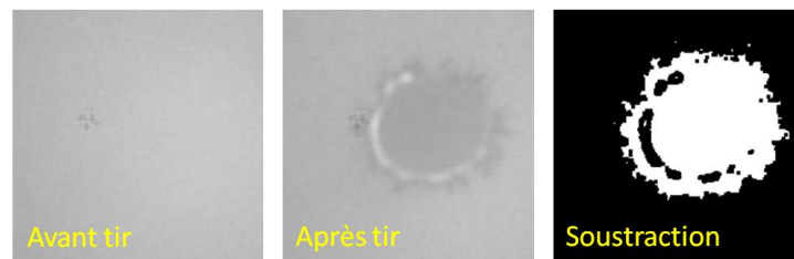
Figure III-5 : Détection in situ d'un endommagement par soustraction des images prises avant et après irradiation laser du site.
