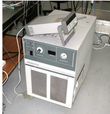
(b) Cryothermostat assurant le refroidissement du circuit d'eau glycolée
