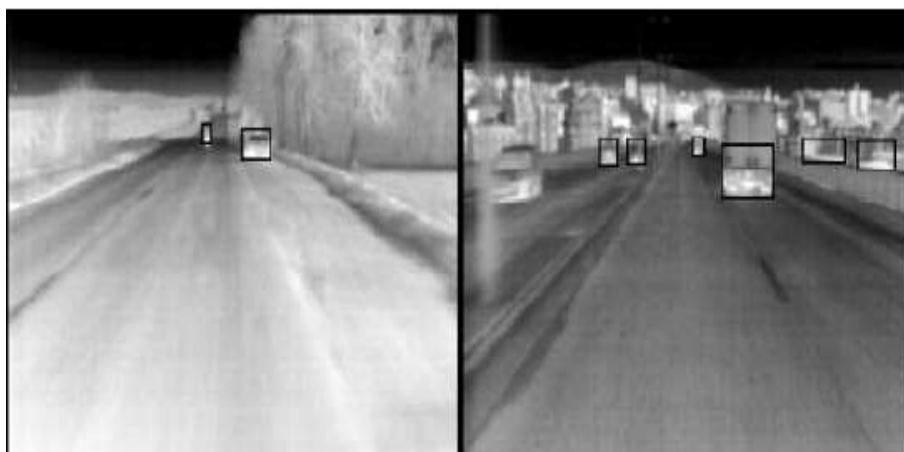
Figure 2.31 — Détection de véhicules par IR : rectangles noirs
