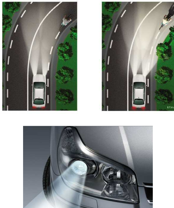
Figure 1.14 — Les projecteurs à xénon bidirectionnels
