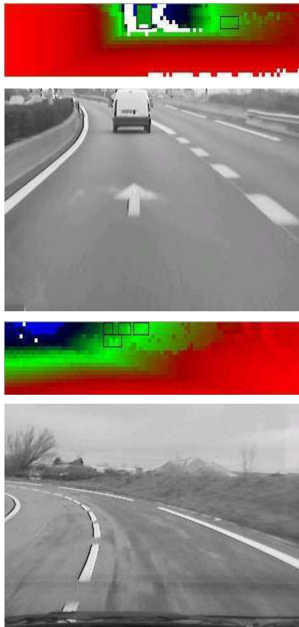
Figure 2.25 — Des fausses détections
