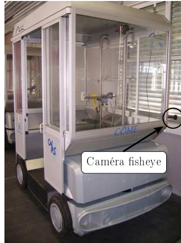
FIG. 5.7 – Véhicule électrique RobuCab muni de la caméra fisheye Fujinon, dirigée vers l'avant du véhicule.
