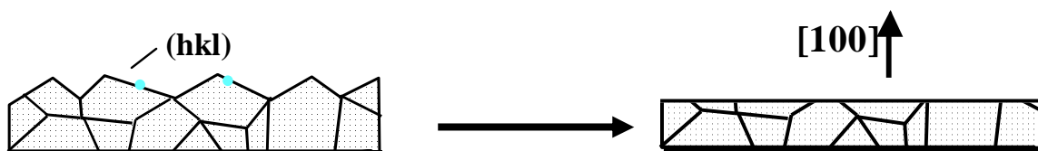
Figure IV.22 : Revêtements avant (avec un pré-traitement cathodique) et après polissage électrolytique.
