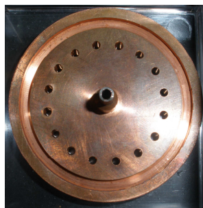
Figure II.28 : Anode de cuivre utilisée pour les analyses.
