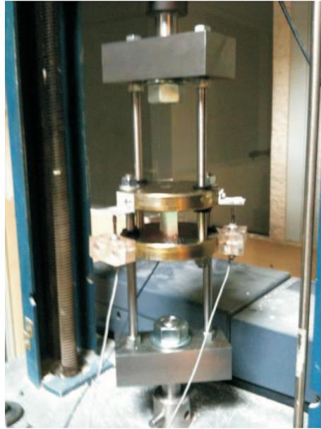
FIG. 3.28 – Banc de charge mécanique pour les essais en compression et position des capteurs de mesure de déplacement. Les capteurs sont espacés de  $120^\circ$ .
