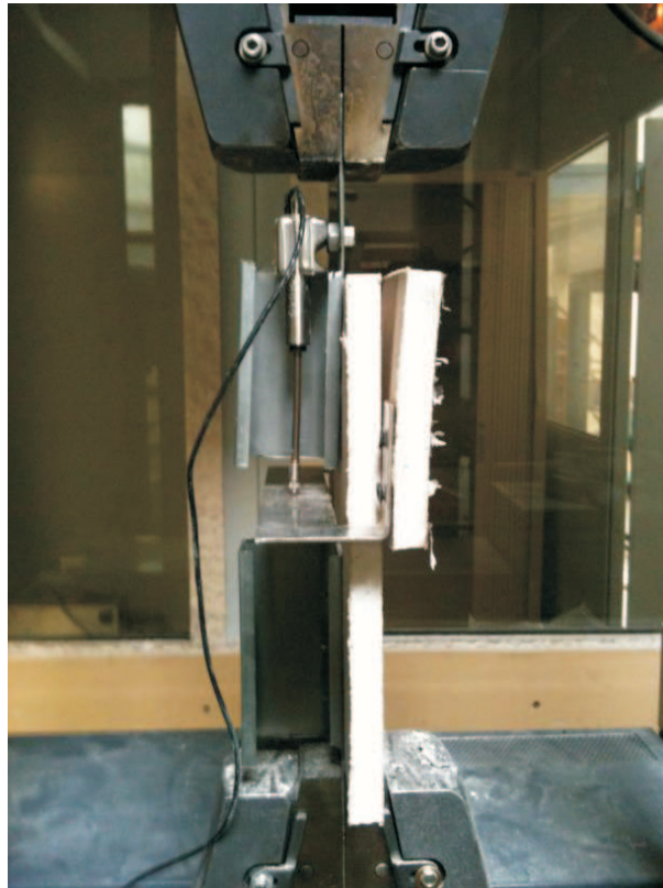
FIG. 4.2 – Banc d'essai réalisé dans la configuration pour des mesures en cisaillement de l'assemblage par vissage de type 2, à chaud.
