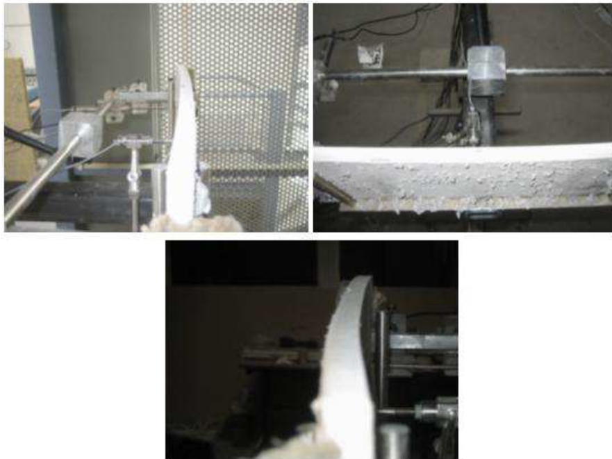
FIG. 3.5 – Déformation de la plaque CPC en parement simple après 15 mn de charge thermique par le BCT .
