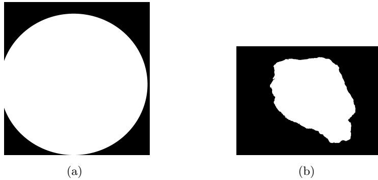
Fig. 5.5 – Masques binaires utilisés pour exclure les arrière-plans des processus de reconstruction 3-D pour les séquences : (a) du greffon cornéen ; (b) du grain de sable.
