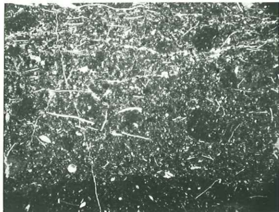
limite d'une zone micritique et d'une autre plus graveleuse III 5 (x 35) Ln
