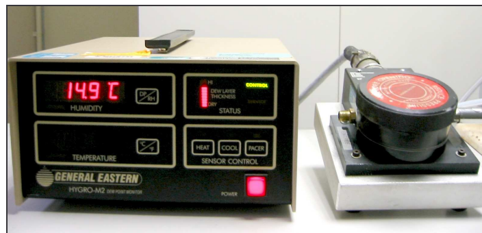
Figure 11. Exemple d'hygromètre à condensation.
