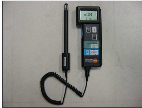
Figure 9. Exemple d'hygromètre à variation d'impédance.
