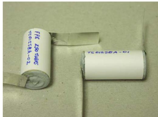
(b) fabrication TLP Inc., condensateur  $6.8 nF$  -  $800 V$  [30].
