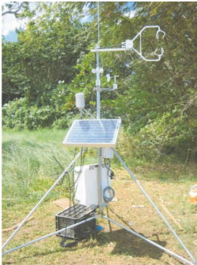
FIGURE 1.7: Trépied mobile de 3 m utilisé lors des prospections pour implanter le mât fixe de 10 m et tester les instruments de mesure.
