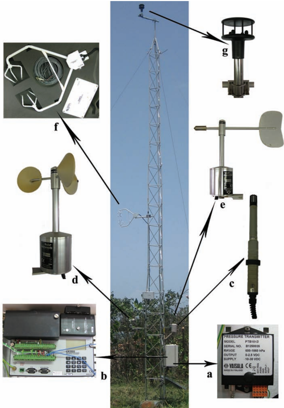
FIGURE 1.9: Mât instrumenté sur lequel sont placés : à l'intérieur du coffret le baromètre (a) et la centrale d'acquisition (b), le capteur de température et d'humidité (c), l'anémomètre à coupelles (d), la girouette (e), l'anémomètre sonic 3D (f) et l'anémomètre sonic 2D (g).
