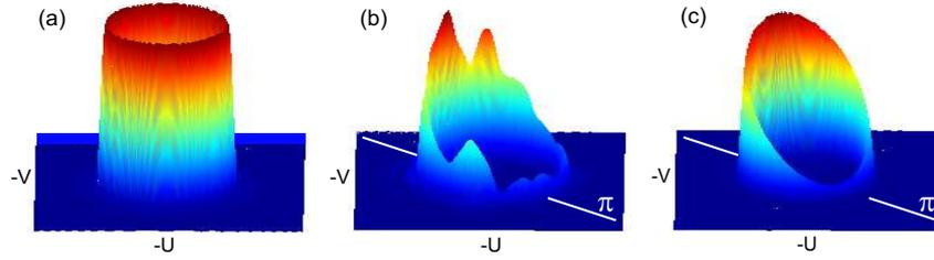
FIG. 2.33 – Spectre d’ondes planes de l’amplitude du champ transverse  $\sqrt{E_x(x,y)^2 + E_y(x,y)^2}$  dans le cas (a) idéal et (b) expérimental. (c) : (a) modulé par un cosinus en fonction de l’angle azimutal : simulation d’un faisceau de Bessel asymétrique qui se rapproche du faisceau expérimental.
