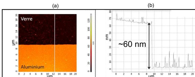
FIG. 1.20 – (a) Image AFM et (b) profil sur la ligne blanche d'une marche (titane + Aluminium sur verre).
