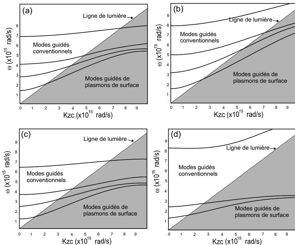
FIG. 3.14 – Courbes des dispersion des premiers modes guidés du guide d'onde à section ouverture papillon (avec  $D = 275 \text{ nm}$ ,  $G = 55 \text{ nm}$  et  $\theta = 45^\circ$ ) pour les quatre autres métaux : (a) Al, (b) Ag, (c) Cu, et (d) W.
