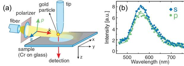
FIG. 1.5 – (a) Schéma de l’expérience et (b) Spectres des signaux détectés pour les polarisations  $p$  et  $s$  du faisceau incident [42].
