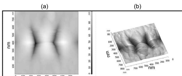
FIG. 1.32 – (a) Image AFM d’une nano-ouverture papillon possédant comme gap un carré de  $70\text{ nm}$  de côté et de dimensions  $320\text{ nm} \times 320\text{ nm}$  et (b) vue 3D de l’ouverture papillon.
