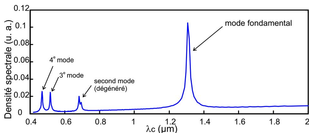
FIG. 3.11 – Densité spectrale en fonction de la longueur d'onde de coupure ( $k_z = 0$ ) du guide d'onde en or. Les paramètres de l'ouverture papillon sont :  $\mathbf{D} = 275 \text{ nm}$ ,  $\mathbf{G} = 55 \text{ nm}$  et  $\theta = 45^\circ$ .
