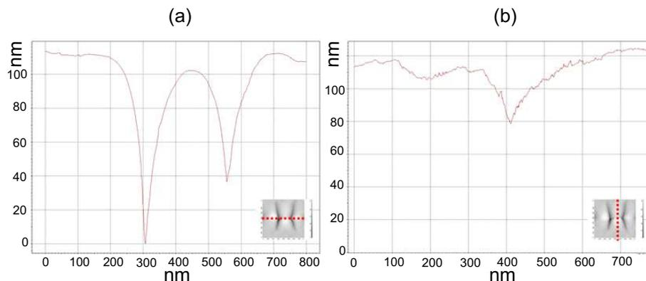
FIG. 1.31 – Profils AFM d’une nano-ouverture papillon sans ouverture du gap et de dimensions  $320\text{ nm} \times 320\text{ nm}$ ; (a) profil selon la ligne horizontale et (b) selon la ligne verticale de l’ouverture papillon (voir inserts).
