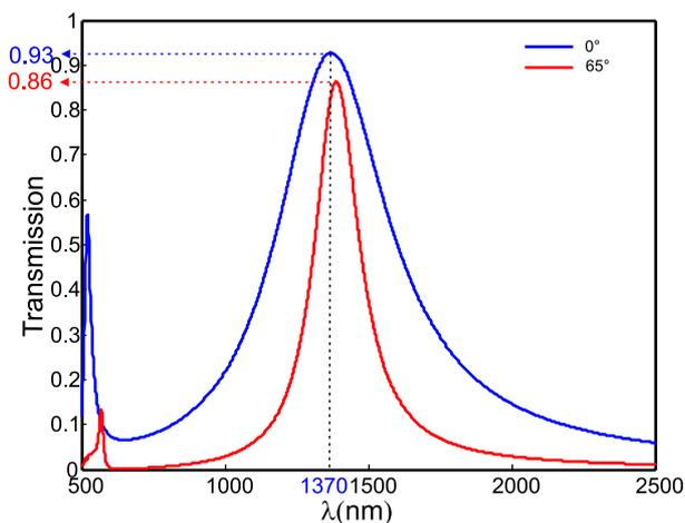
FIG. 3.20 – Spectre de transmission normalisée calculée à la sortie des ouvertures papillons. La structure est illuminée par une onde plane polarisée TE sous incidence normale (bleue) et oblique à  $65^\circ$  (rouge).
