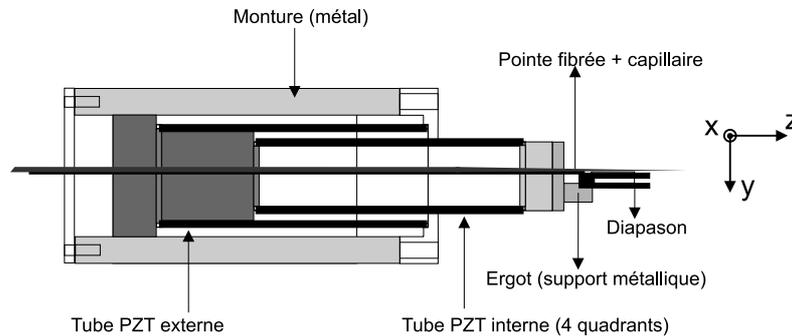
FIG. 2.3 – La tête du microscope SNOM.
