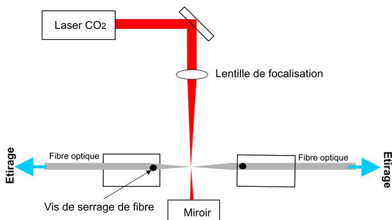
FIG. 2.5 – Principe de fonctionnement du chauffage-étirage.
