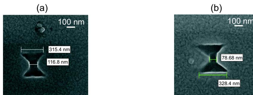
FIG. 1.28 – (a,b) Images MEB des deux nano-ouvertures papillons gravées sur une lame de verre (*dwelltime* = 1 ms, 30 loops, réalisées à MIMENTO).
