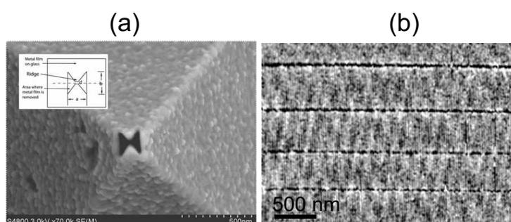
FIG. 1.14 – (a) Image MEB d'une ouverture papillon de dimensions  $160 \text{ nm} \times 160 \text{ nm}$  et de gap  $30 \text{ nm}$ , usinée au bout d'une pointe AFM [64]. (b) Exemple des lignes gravées par AFM au moyen de la nano-ouverture papillon.
