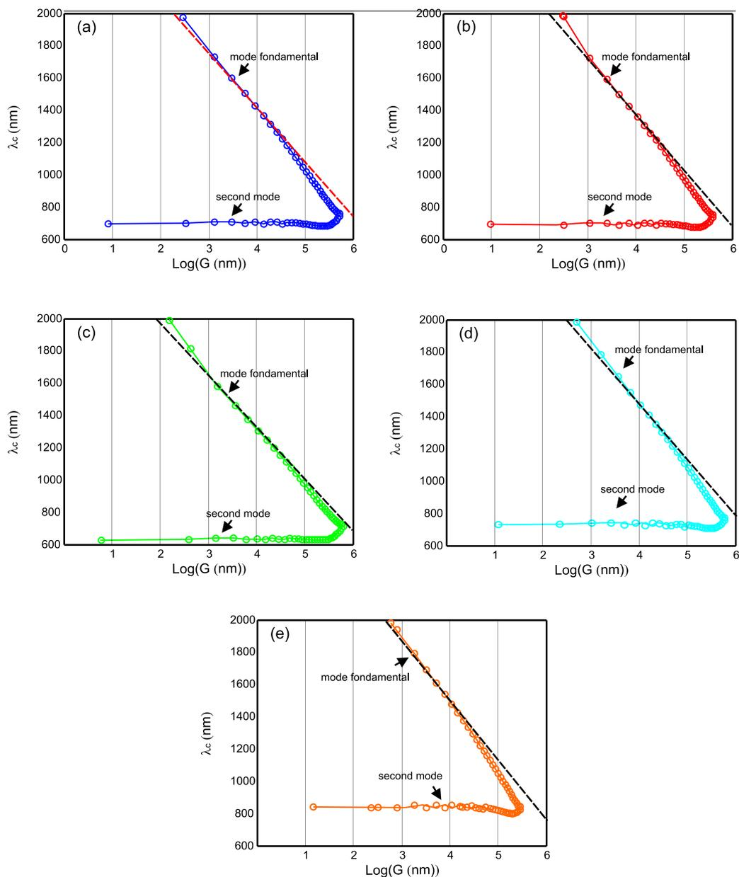
FIG. 3.18 – Longueur d’onde de coupure en fonction du logarithme népérien de  $G$  en fixant les dimensions à  $D = 305 \text{ nm}$ . Les droites en pointillés sont celles obtenues grâce à l’équation 3.16 pour les différents paramètres correspondants au métal approprié.
