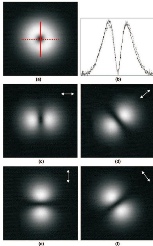
FIG. 2.12 – (a) Exemple de faisceau annulaire polarisé radialement pour la longueur d'onde  $\lambda = 632.8nm$  [15]. (b) Profil suivant les deux traits plein et pointillé sur (a) ; (c-f) Structures à deux grains obtenues après que le faisceau traverse un polariseur dont l'axe est défini par une flèche blanche sur chaque image.
