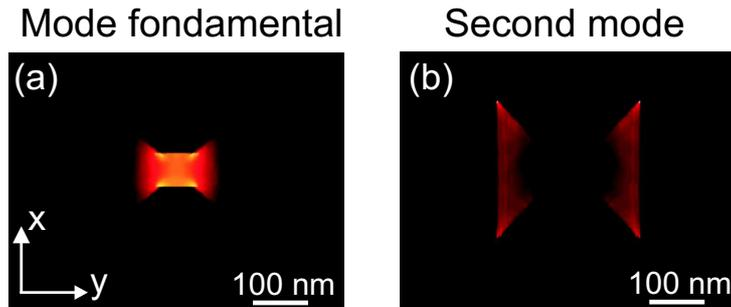
FIG. 3.12 – Distributions d'intensités normalisées ( $|E|^{0.8}$ ) associées aux deux modes propres du guide infini. (a) le premier mode (mode fondamental) à  $\lambda_c = 1302 \text{ nm}$  et (b) le second mode correspondant à  $\lambda_c = 727 \text{ nm}$ .
