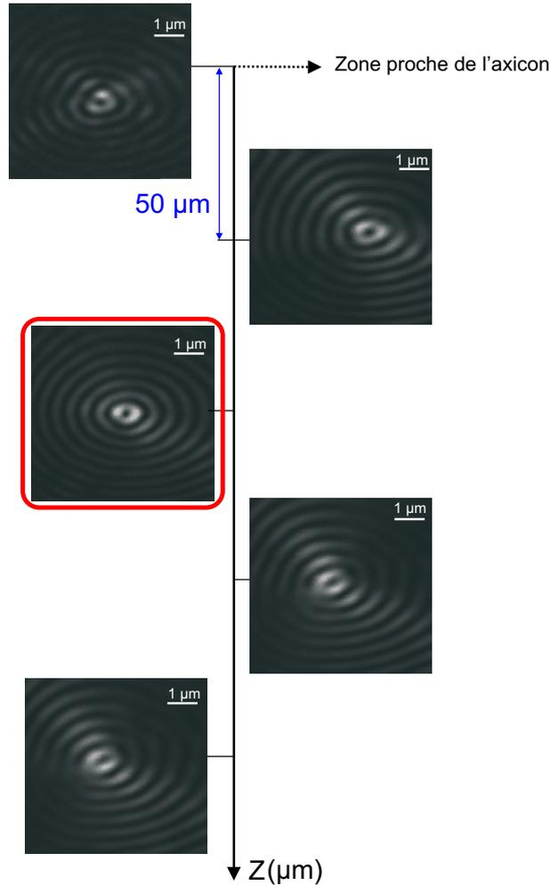
FIG. 2.18 – Images obtenues lorsque le faisceau incident propagatif polarisé radialement est cartographié par la pointe diélectrique balayant la zone de Bessel suivant l'axe "z" pour  $\lambda = 532 \text{ nm}$ .
