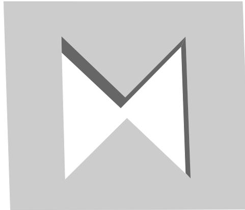
FIG. 1.10 – Schéma d’une nano-ouverture papillon [45].
