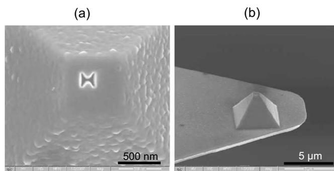
FIG. 1.13 – Vue de haut (a) et de côté (b) d'une image MEB de l'ouverture papillon publiée par Wang & al. (dimensions de l'ouverture :  $180 \text{ nm} \times 180 \text{ nm}$  et la largeur de gap égale à  $33 \text{ nm}$ ) [59].
