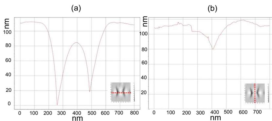
FIG. 1.33 – Profils AFM d’une nano-ouverture papillon de dimensions latérales de  $320\text{ nm} \times 320\text{ nm}$  et possédant un gap carré de côté  $70\text{ nm}$ ; (a) profil selon la ligne horizontale et (b) selon la ligne verticale de l’ouverture papillon (voir inserts).
