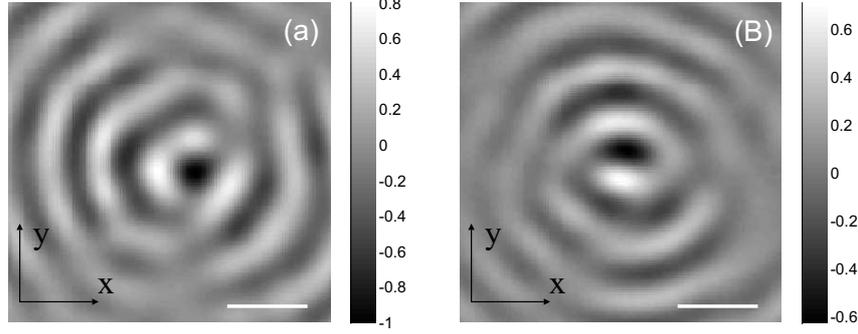
FIG. 2.31 – (a,b) Images des composantes transverses du champ électrique  $E_x = A_x \cos(\phi_x)$  et  $E_y = A_y \cos(\phi_y)$ ;  $A_x$  et  $A_y$  sont les amplitudes et  $\phi_x$ ,  $\phi_y$  les distributions de phases des deux composantes du champ électrique (barre d'échelle :  $0.9\mu\text{m}$ ,  $\lambda = 660\text{ nm}$ ).
