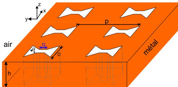
FIG. 3.19 – Schéma de la structure modélisée par la FDTD en incidence oblique :  $h$  représente l'épaisseur de la couche métallique,  $P$  la période suivant les directions  $x$  et  $y$ ,  $D$  la dimension de l'ouverture papillon,  $G$  le gap de l'ouverture papillon et  $\theta$  l'angle sur les ailes du papillon.
