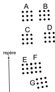
FIG. 1.34 – Schéma de l'échantillon des nano-ouvertures papillons caractérisé optiquement.
