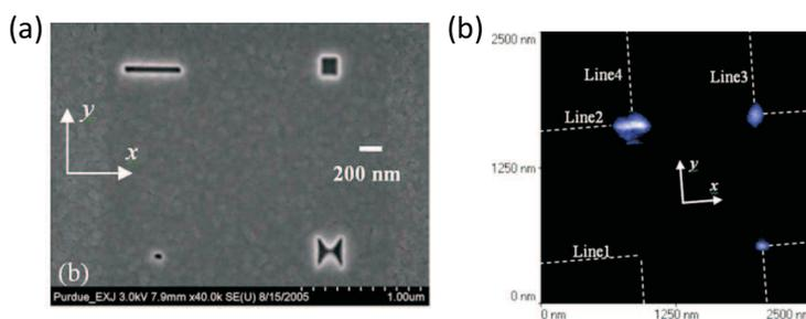
FIG. 1.12 – (a) Images FIB des ouvertures tests usinées par E.X. Jin & al. [63], (b) images du champ lumineux à la sortie des ouvertures tests.
