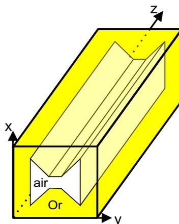
FIG. 3.10 – Schéma du guide d'onde à section papillon. Un repère en coordonnées cartésiennes est affiché afin d'orienter l'espace pour la modélisation.
