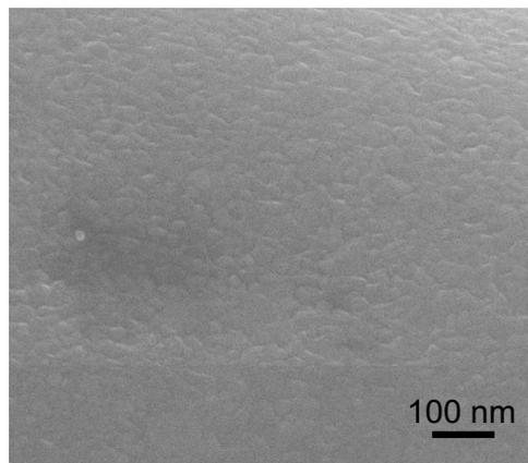
FIG. 1.44 – Image MEB de l'état de surface montrant la rugosité de la couche d'aluminium sur le flanc de la pointe.
