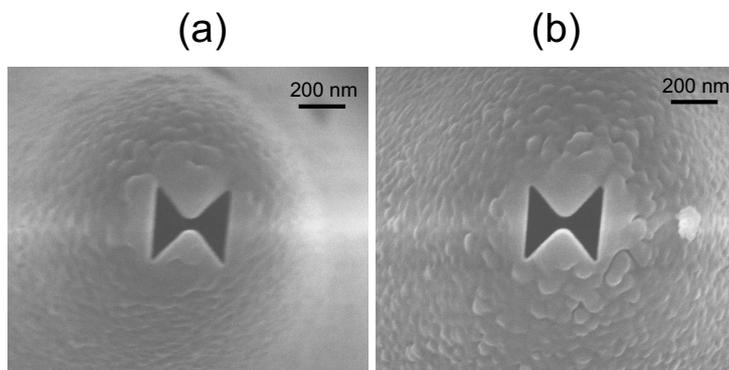
FIG. 1.50 – Image MEB d'une ouverture papillon réalisée avec les paramètres de gravure suivants : courant du faisceau égal à 9 pA et  $dw = 100s$ ; (a) vue du côté de la pointe ; (b) zoom sur la partie où se situe l'ouverture papillon.
