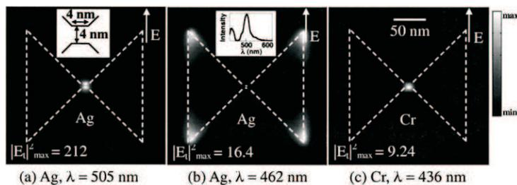
FIG. 1.11 – Réponse d’une nano-ouverture bowtie (a,b) en argent et (c) en chrome à différentes longueurs d’ondes (indiquées sur les images). La réponse est ici donnée par l’intensité du champ électrique à 5 nm du plan de sortie de l’ouverture (côté air), pour une même polarisation [62].
