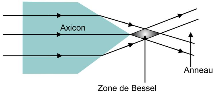
FIG. 2.14 – Schéma d'un axicon et tracé des rayons lumineux transmis.
