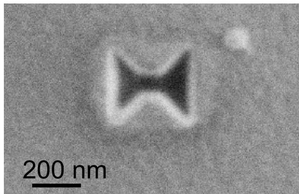
FIG. 1.27 – Image FIB d’une nano-ouverture papillon ayant comme gap un carré de 70 nm et de dimensions  $320\text{ nm} \times 320\text{ nm}$  (*dwelltime* = 1 ms, 30 loops).
