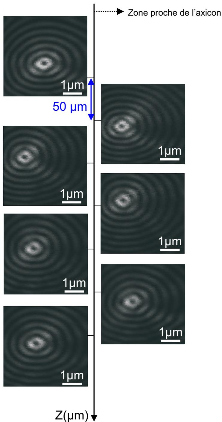
FIG. 2.20 – Images obtenues lorsque le faisceau incident propagatif polarisé radialement est cartographié par la pointe diélectrique (pointe obtenue après chauffage-étirage d'une fibre monomode à  $514 \text{ nm}$ ) imageant la zone de Bessel suivant une succession de plans transverses pour  $\lambda = 532 \text{ nm}$ .
