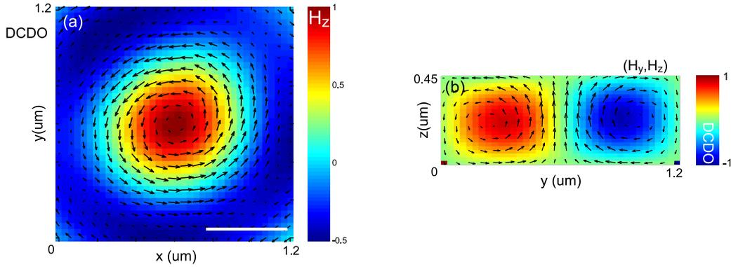
FIG. 2.30 – Interaction entre la densité de courant de déplacement optique(DCDO) et le champ magnétique au centre du faisceau. (a) plan transverse, composante du champ magnétique  $H_z$  (fausses couleurs) et les lignes de DCDO (flèches noires). (b) plan longitudinal ( $x=0$ ), la composante  $j_{Dx}$  de DCDO (fausses couleurs) et les lignes de champ magnétique (flèches noires).
