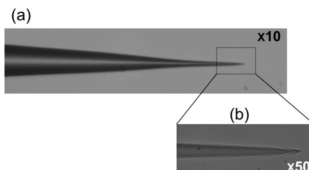
FIG. 2.8 – Image au Microscope optique classique (a) d'une pointe obtenue avec une fibre optique monomode à 514 nm par chauffage-étirage ( $\times 10$ ) et (b) zoom sur l'apex de la pointe ( $\times 50$ ).
