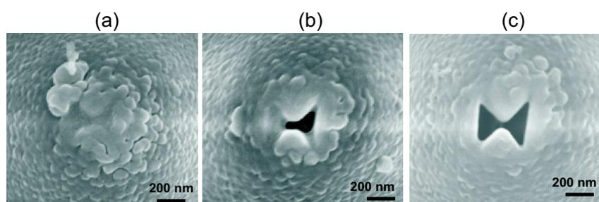
FIG. 1.47 – Usinage FIB de nano-ouvertures papillons sur pointes polymères métallisées, avec (a)  $dw = 4s$ , (b)  $dw = 90s$  et (c)  $dw = 120s$  et un courant de faisceau égal à 1 pA.
