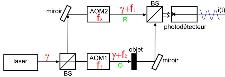
FIG. 2.10 – Schéma de principe d'une détection hétérodyne optique.
