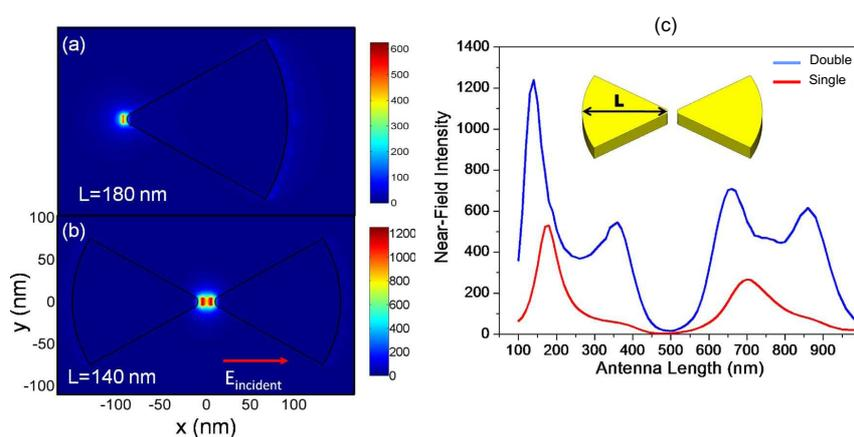
FIG. 1.4 – Distribution d’intensité champ proche (a) au voisinage d’un triangle en or de dimensions  $L = 180 \text{ nm}$  et (b) au voisinage de la structure papillon en or (ou un couple de triangle) avec  $L = 140 \text{ nm}$  et un gap de 20 nm. (c) Intensité champ proche du triangle (en rouge) et du papillon (en bleu) calculée en fonction de la longueur  $L$ .
