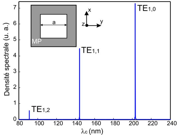
FIG. 3.5 – Densité spectrale ( $k_z = 0$ ) pour les modes TE du guide d'onde à section carrée, en métal parfait (vue 2D du guide d'onde en métal parfait, à section carrée de côté égal à  $a = 100 \text{ nm}$  avec une invariance suivant l'axe  $z$ ).
