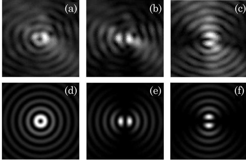
FIG. 2.25 – (a-c) Acquisitions du faisceau de Bessel évanescent polarisé radialement à travers les canaux D3, D2 et D1 respectivement (voir figure 2.2). Simulation des champs vectoriels du faisceau de Bessel évanescent dans le plan transverse : (d) intensité du champ électrique totale ; (e,f) intensité des composantes transverses  $E_x$  et  $E_y$ , respectivement. Taille des images :  $2,7 \mu\text{m} \times 2,7 \mu\text{m}$ , longueur d'onde :  $\lambda = 632.8 \text{ nm}$ .
