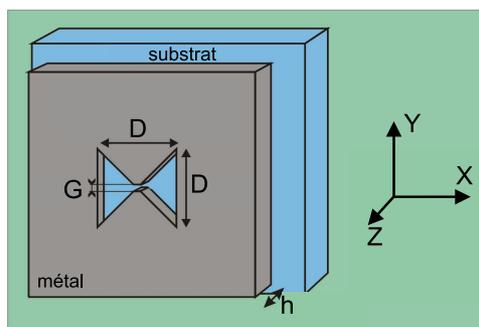
FIG. 1.15 – Schéma du modèle de nano-ouverture papillon considéré dans nos simulations.
