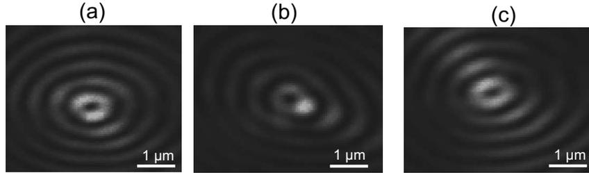
FIG. 2.17 – Images obtenues lorsque le faisceau incident propagatif polarisé radialement est cartographié par la pointe diélectrique balayant la zone de Bessel pour  $\lambda = 632,8 \text{ nm}$ , (a) image expérimentale brute obtenue avec une pointe monomode à 630 nm, (b) image expérimentale brute obtenue avec la même pointe que (a) tournée de  $90^\circ$ , et (c) image expérimentale brute obtenue avec une autre pointe monomode à 630 nm, fabriquée de la même manière que la première pointe.
