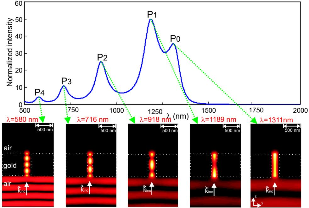
FIG. 3.9 – (a) Spectre d'intensité champ proche normalisée en fonction de la longueur d'onde pour  $h = 800 \text{ nm}$  à  $5 \text{ nm}$  au dessus du gap. Coupe dans le plan  $(x, z)$  des distributions d'intensité normalisées ( $|E|^{0.4}$ ) pour les différents pics de transmission. Les paramètres de l'ouverture papillon restent les mêmes que ceux de la figure 3.7.
