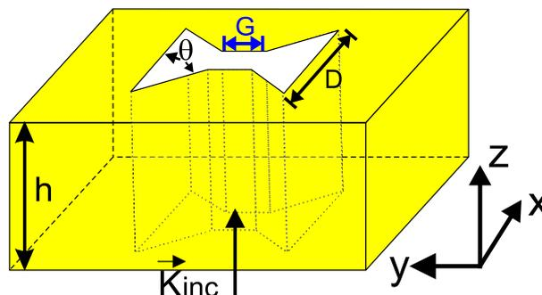
FIG. 3.6 – Schéma en perspective de l'ouverture papillon modélisée par FDTD-3D dont  $h$  représente l'épaisseur du métal considéré,  $D$  la dimension de l'ouverture,  $G$  le gap entre les deux parties métalliques et l'angle du papillon est donnée par  $\theta$ .
