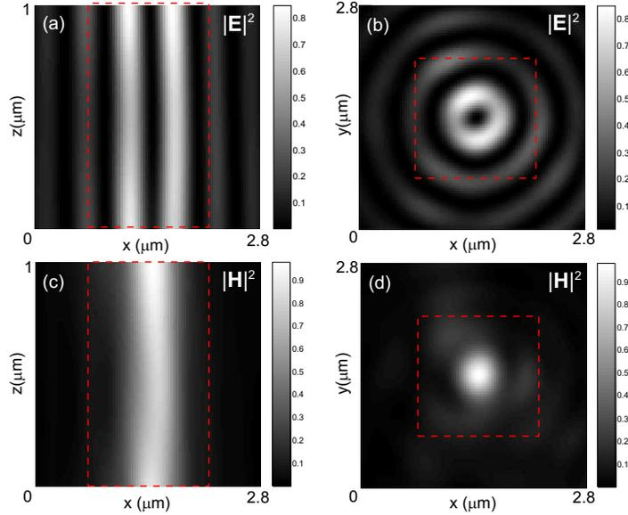
FIG. 2.27 – Distributions d'intensité d'un faisceau de Bessel propagatif polarisé azimuthalement reconstruites au moyen des données expérimentales mesurées dans le plan  $z = 0$  : (a,b) intensité du champ électrique et (c,d) intensité du champ magnétique. La représentation est effectuée (a,c) dans un plan longitudinal ( $y=0$ ) et (b,d) dans le plan transverse ( $z=0$ ). Les champs sont exprimés en unités Gaussienne (ou CGS).
