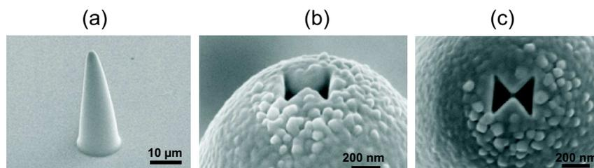
FIG. 1.48 – Images MEB des pointes usinées avec les paramètres suivants : courant du faisceau égale à 10 pA et  $dw=4s$  : (a) vue de la pointe entière, (b) zoom sur le sommet de la pointe et (c) vue de face de l'ouverture papillon.
