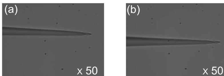
FIG. 2.7 – Pointes sur fibre optique monomode à 630 nm obtenues par chauffage-étirage sous faisceau laser et visualisées sous microscope optique classique ( $\times 50$ ). Les paramètres de la procédure de fabrication sont : (a)  $D = 0,15s$ ,  $H = 320$ ,  $V = 18$  et  $P = 151$ ; (b)  $D = 0,14s$ ,  $H = 320$ ,  $V = 18$  et  $P = 151$ .
