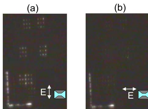
FIG. 1.36 – Images par microscopie optique classique (objectif :  $\times 100$  ; 0,9) à  $\lambda = 1.55\mu\text{m}$  de l'échantillon présenté sur la figure 1.34. La polarisation incidente est (a) parallèle et (b) perpendiculaire aux triangles métalliques des structures.
