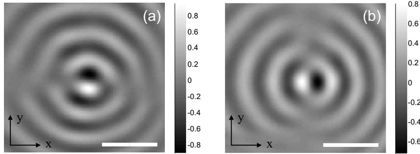
FIG. 2.26 – (a,b) Images des composantes transverses orthogonales du champ électrique  $E_x = A_x \cos(\phi_x)$  et  $E_y = A_y \cos(\phi_y)$ ;  $A_x$  et  $A_y$  sont les amplitudes et  $\phi_x$ ,  $\phi_y$  les distributions des phases des deux composantes orthogonales du champ électrique (barre d'échelle :  $2\mu\text{m}$ ).
