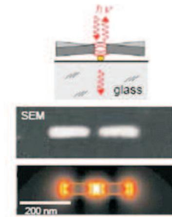
FIG. 1.6 – Antenne " demi-onde " optique résonante [43].
