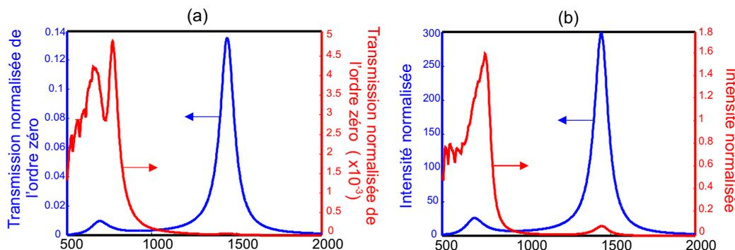
FIG. 1.16 – (a) Spectre de transmission normalisé calculé en champ lointain de l'ordre zéro de diffraction ; (b) Spectre d'intensité normalisé calculé à 10 nm en un point situé au dessus du gap de la structure bowtie. Les traits en violet et en rouge correspondent respectivement à la polarisation Y et X dans la figure 1.15. Les paramètres de l'ouverture papillon sont fixés à  $D=305$  nm,  $G=55$  nm, pour une épaisseur d'or  $h=100$  nm.
