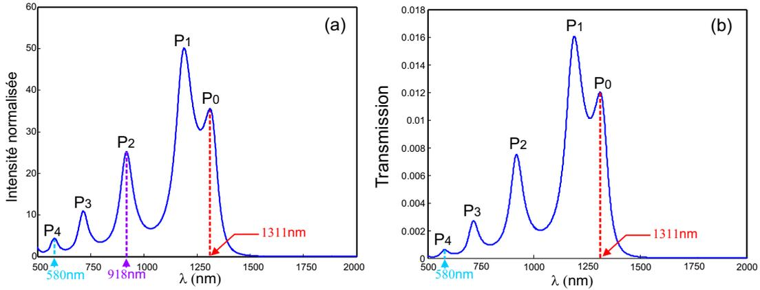
FIG. 3.8 – (a) présente le spectre normalisé de l'intensité électrique champ proche en fonction de la longueur d'onde pour  $h = 800 nm$  calculé à 5 nm au dessus du gap. (b) correspond au spectre normalisé de l'intensité électrique de l'ordre zéro diffracté (champ lointain). Les paramètres de l'ouverture papillon restent les mêmes que ceux de la figure 3.7.
