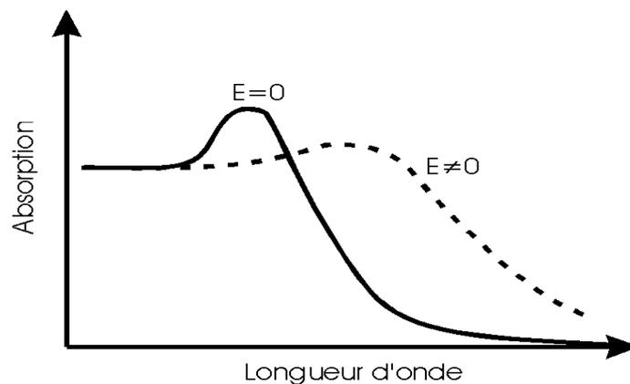
Fig. II-8 : Illustration du décalage vers le rouge induit par l'effet Stark confiné dans les puits quantiques multiples. Sous l'influence d'un champ électrique  $E$ , l'exciton se déplace et s'atténue [II.10]
