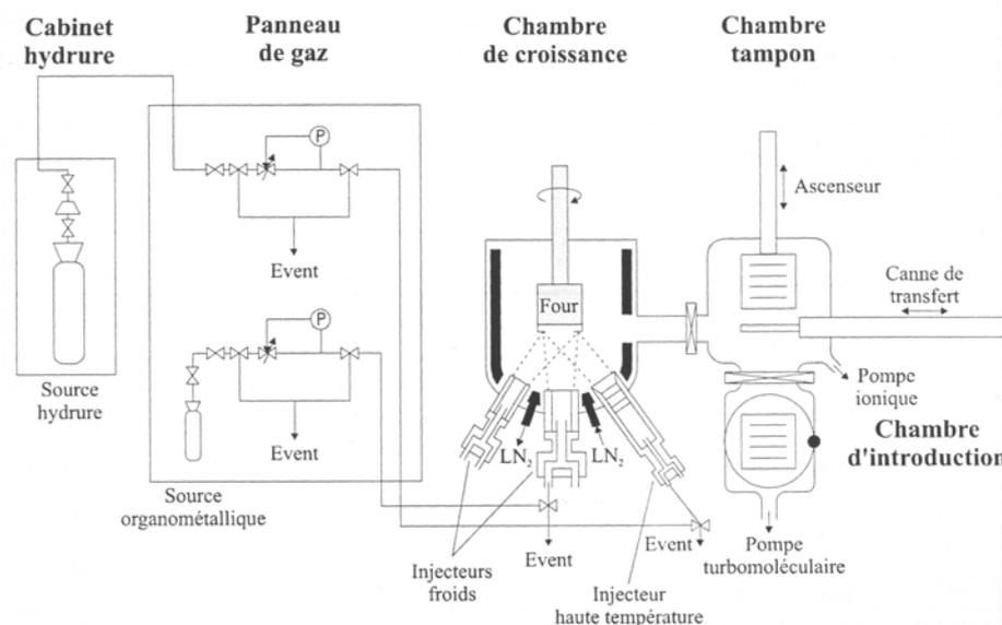
Fig. I-5 : Schéma de principe d'un réacteur CBE.
