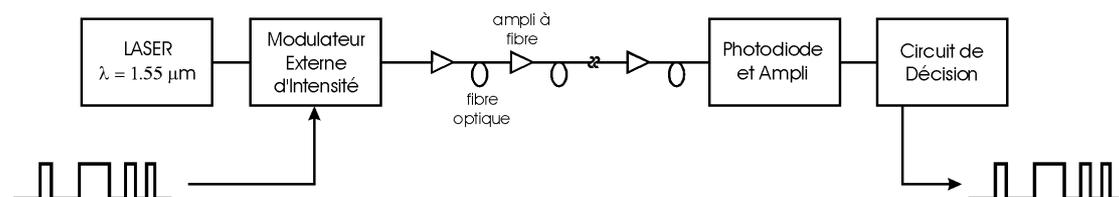
*Fig. 1 : Configuration typique d'un système de transmission de données binaires par modulation externe du flux lumineux d'un laser semi-conducteur fonctionnant en régime continu. La ligne est constituée par une alternance de fibres monomodes et d'amplificateurs optiques à fibre dopée Erbium.*
