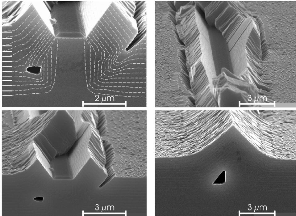
*Fig. I-29 : Images MEB de différents rubans de  $3 \mu\text{m}$  de hauteur recouverts par  $250 \text{ nm}$  de  $\text{Si}_3\text{N}_4$  sur le même échantillon repris en MOVPE sans addition de TBCL à  $620^\circ\text{C} - 100 \text{ mbar}$ .*
