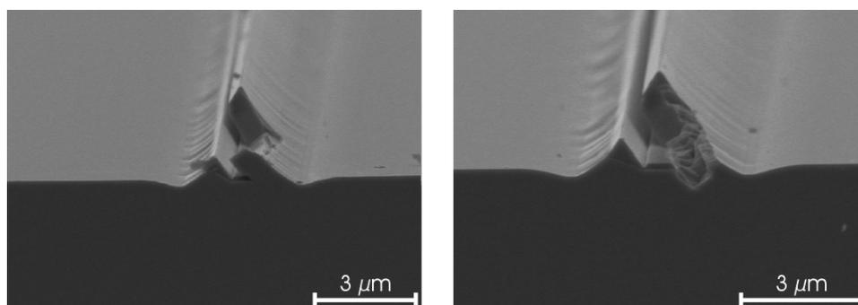
Fig. I-31 : Images MEB de rubans de  $3 \mu\text{m}$  de hauteur recouvert par  $250 \text{ nm}$  de  $\text{Si}_3\text{N}_4$  repris en MOVPE sans adition de TBCl à  $670^\circ\text{C} - 100 \text{ mbar}$ .
