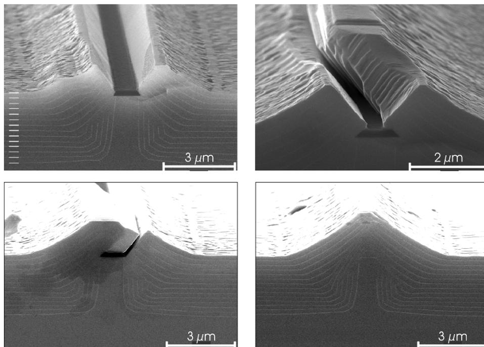
Fig. I-30 : Images MEB de différents rubans de  $3 \mu\text{m}$  de hauteur recouverts par  $250 \text{ nm}$  de  $\text{Si}_3\text{N}_4$  sur le même échantillon repris en MOVPE sans adition de TBCl à  $635^\circ\text{C} - 100 \text{ mbar}$ .
