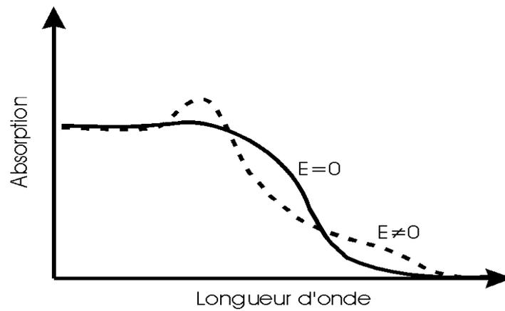
Fig. II-7 : Spectre d'absorption typique de la localisation de Wannier-Stark dans un superréseau. L'application d'un champ électrique  $E$  provoque, dans l'ordre des longueurs d'onde croissantes, l'apparition de l'exciton, le décalage vers le bleu puis le décalage vers le rouge du bord d'absorption [II.6].
