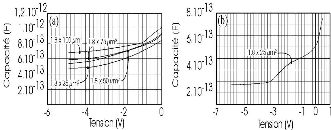
Fig. IV-10 : Mesures de capacité sur plaque entière de modulateurs SIBH contenant un ruban de  $1.8 \mu\text{m}$  de large en fonction de la longueur (25 à  $100 \mu\text{m}$ ) du guide (a) et sur puces clivées de modulateurs SIBH contenant un ruban de  $1.8 \mu\text{m}$  de large et  $25 \mu\text{m}$  de long (b).
