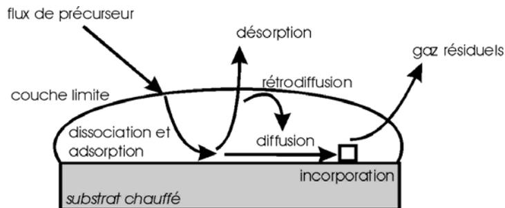
Fig. I-8 : Schéma du modèle de la couche limite.
