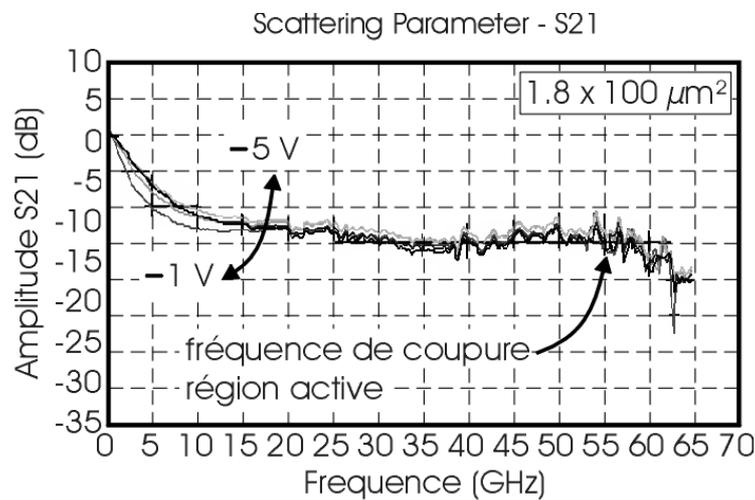
Fig. IV-18 : Observation d'une forte diminution du signal (Roll-Off) pour les basses fréquences (< 15 GHz) indépendamment de la tension de commande entre  $-1 \text{ V}$  et  $-5 \text{ V}$  pour un modulateur SIBH à base d'AlGaInAs de  $1.8 \times 100 \mu\text{m}^2$ . La fréquence de coupure correspondant à la région active est autour des 55 GHz.
