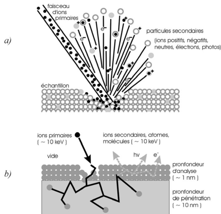
Fig. III-5 : Schéma de principe de la collision d'un faisceau d'ions primaires avec un échantillon. a) pulvérisation b) implantation.
