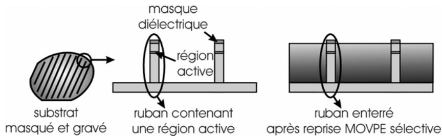
*Fig. I-10 : Schéma de principe d'une reprise d'épitaxie MOVPE de façon sélective sur un substrat possédant des rubans gravés et masqués par un diélectrique.*
