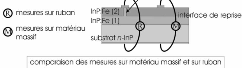
Fig. III-16 : Schéma de principe des mesures ISOELEC.
