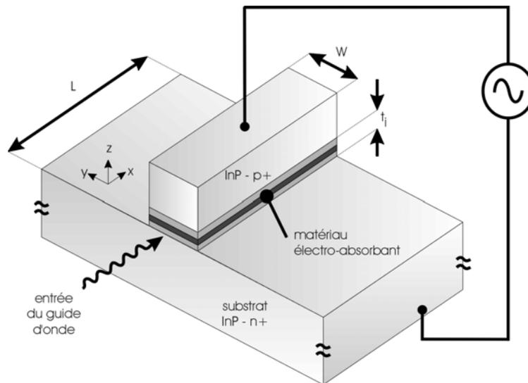
*Fig. II-9 : Structure d'un guide d'onde en arrête contenant un matériau électroabsorbant dans le cœur du guide. L'utilisation de matériaux dopés permet l'application d'un champ électrique sur l'étendue de la région intrinsèque d'épaisseur  $t_i$ .  $W$  et  $L$  représentent la largeur et la longueur de cette région.*
