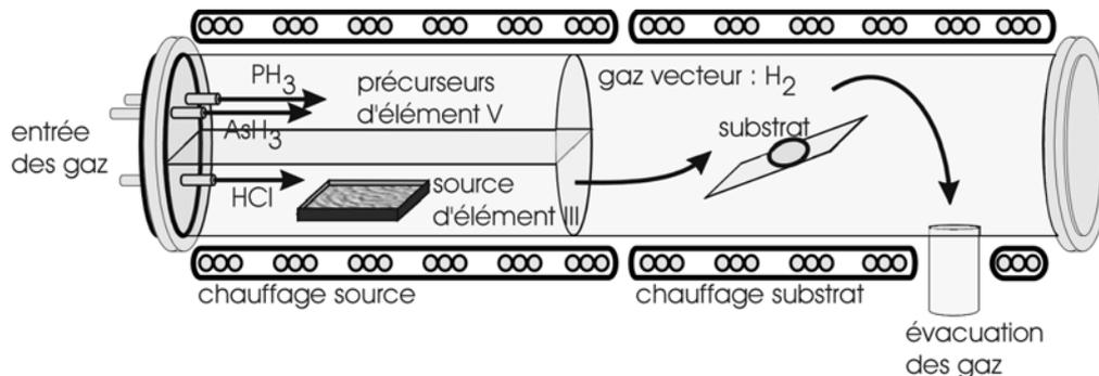
Fig. I-3 : Schéma d'un réacteur HVPE : les précurseurs d'éléments V sont gazeux de type  $PH_3$  et  $AsH_3$ , alors que les précurseurs d'éléments III sont des solides liquéfiés transportés par le gaz vecteur  $HCl$  sous forme de  $III-Cl$ .
