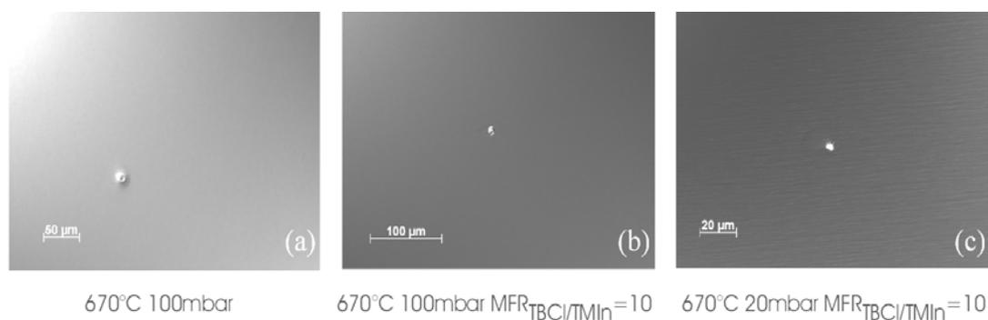
Fig. I-22 : Evolution de la morphologie de surface de couches d'InP épitaxiées à 670°C – 20 mbar et 100 mbar sans (a) et avec (b et c) ajout de TBCL.
