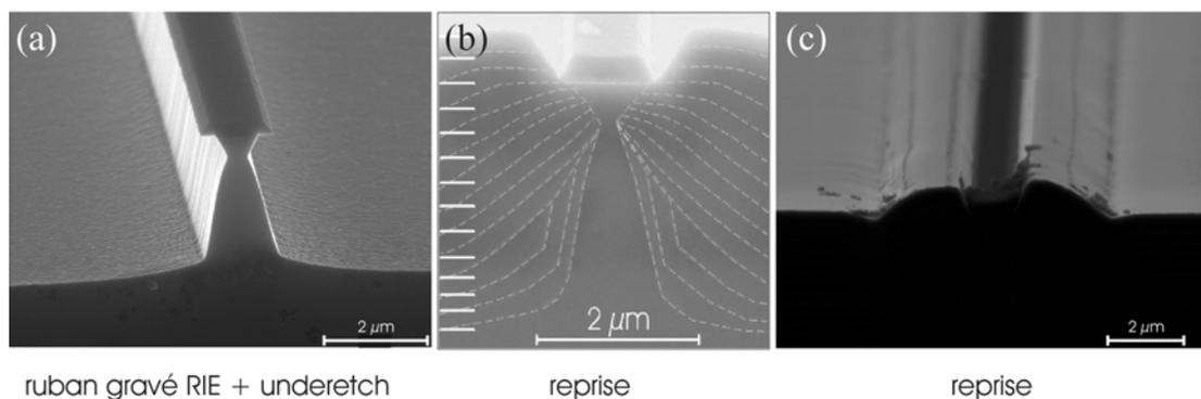
Fig. I-28 : Images MEB d'un ruban d'InP de 3  $\mu\text{m}$  de hauteur recouvert par un masque diélectrique ( $\text{SiN}_x$ ) de 250 nm d'épaisseur gravé par RIE (a) et repris en MOVPE sans addition de Chlore (b et c).
