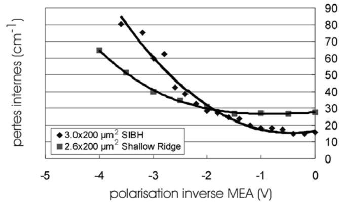
Fig. IV-13 : Calcul des pertes internes du guide optique pour un modulateur « Shallow-Ridge » de  $2.6 \times 200 \mu\text{m}^2$  et un modulateur SIBH de  $3.0 \times 200 \mu\text{m}^2$ , contenant tous les deux la même région active à base d'AlGaInAs.
