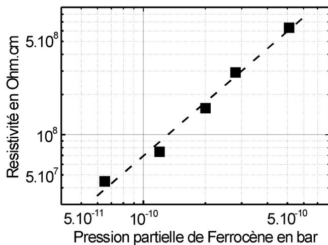
Fig. II-24 : Evolution de la résistivité de l'InP : Fe mesurée par  $I(V)$  en fonction de la pression partielle de Ferrocène dans le réacteur dans le cas d'une couche d'InP : Fe épitaxiée à  $670^\circ\text{C} - 20 \text{ mbar}$ . La dépendance est linéaire sur un dopage allant de  $2 \cdot 10^{16} \text{ cm}^{-3}$  à  $1 \cdot 10^{17} \text{ cm}^{-3}$ .
