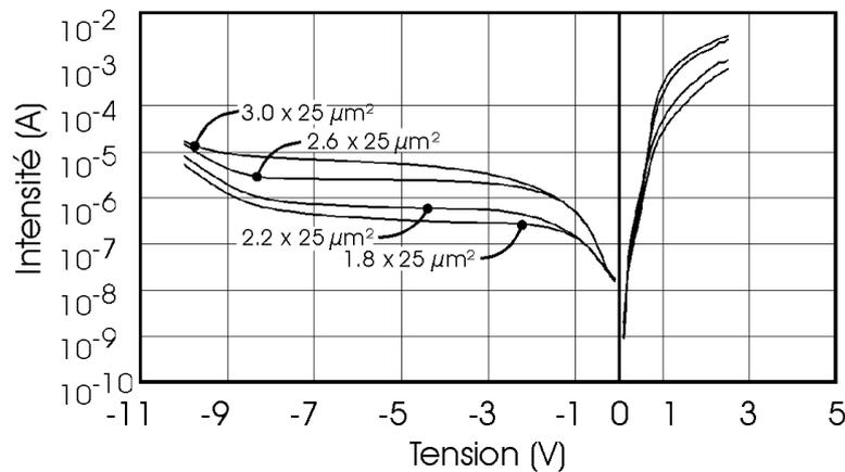
Fig. IV-8 : Mesures  $I(V)$  de courants de fuite sur plaque entière de modulateurs SIBH de  $25\text{ }\mu\text{m}$  de long en fonction de la largeur du ruban ( $1.8$  à  $3\text{ }\mu\text{m}$ ). Les mesures sont donc limitées par l'isolation électrique entre les modulateurs sur le même ruban.
