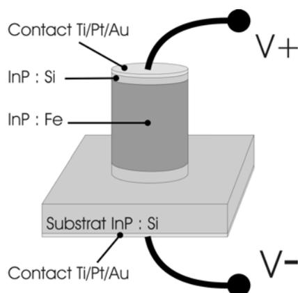
Fig. II-23 : Représentation d'une structure de test pour la mesure de la résistivité de l'InP : Fe. Le substrat est dopé à environ  $2 \cdot 10^{18} \text{ cm}^{-3}$  et la couche de contact InP : Si à  $5 \cdot 10^{17} \text{ cm}^{-3}$ .
