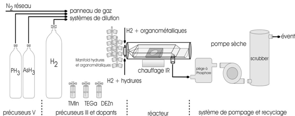
Fig. I-16 : Schéma de principe d'un bâti MOVPE monowafer de type AIXTRON 200.
