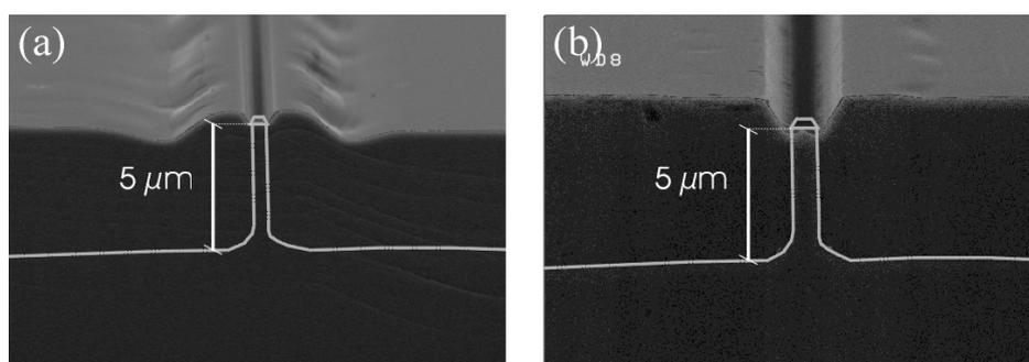
Fig. I-48 : Images MEB de rubans de 5  $\mu\text{m}$  de haut et 1.5  $\mu\text{m}$  de large repris à 700°C – 100 mbar avec MFR TBCl/TMIn = 10 effectuée sur équipement HHI (a) et sur équipement OPTO+ (b).
