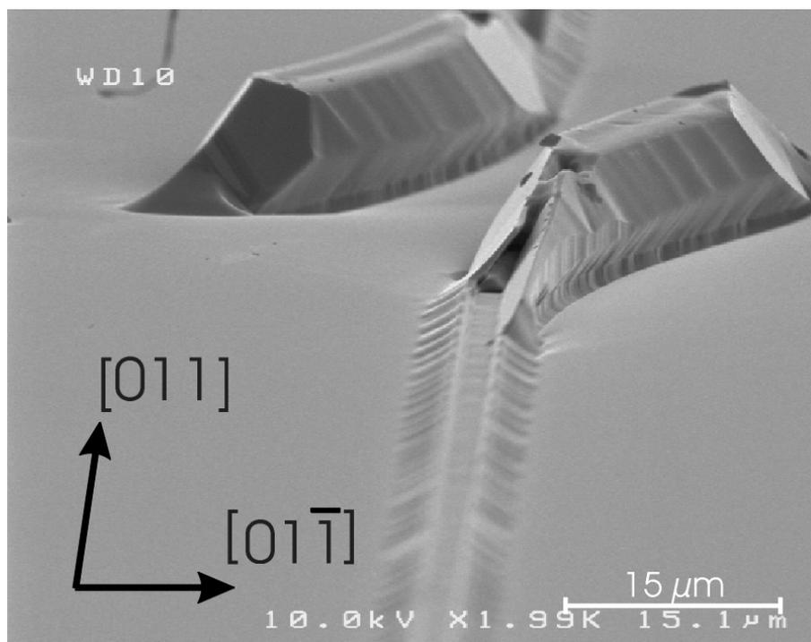
Fig. I-47 : Image MEB d'un ruban de 5  $\mu\text{m}$  de haut et 1.5  $\mu\text{m}$  de large repris, à 700°C – 100 mbar avec un MFR TBCl/TMIn = 10, mais dont le chemin initial a changé progressivement de direction cristallographique.
