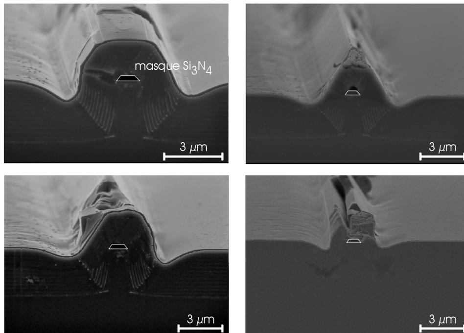
Fig. I-34 : Images MEB de différents rubans de  $3\ \mu\text{m}$  de hauteur sur le même échantillon repris en MOVPE sans adition de TBCl à  $700^\circ\text{C} - 150\ \text{mbar}$ .
