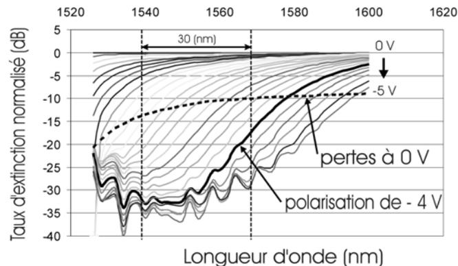
*Fig. IV-14 : Evolution du taux d'extinction en fonction de la longueur d'onde de modulateurs SIBH à base d'AlGaInAs de  $1.8 \times 100 \mu\text{m}^2$  pour différentes tensions de polarisation (0 à -5 V). La réponse type pour une polarisation à -4 V est en gras. La courbe en pointillés correspond à la mesure spectrale des pertes d'insertion.*
