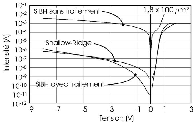
Fig. IV-9 : Mesures  $I(V)$  de courants de fuite de modulateurs SIBH avant traitement de l'interface de reprise, après traitement et sur des modulateurs « Shallow-Ridge » de  $100 \mu\text{m}$  de long et  $1.8 \mu\text{m}$  de large.
