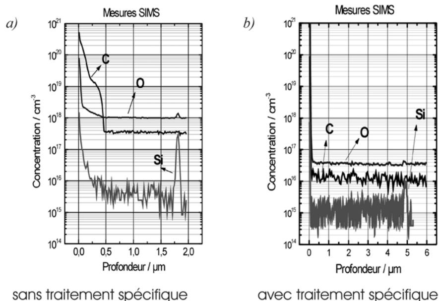
Fig. III-27 : Mesures SIMS sur échantillon préparé avec un nettoyage *ex-situ* seul (a) et avec le traitement *in&ex-situ* (nettoyage C combiné à un recuit puis une gravure *in-situ*) (b).
