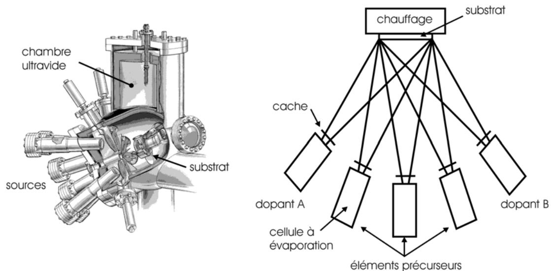
Fig. I-4 : Schéma de principe d'un réacteur MBE.
