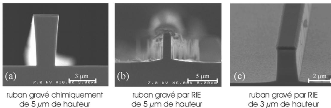
Fig. I-27 : Images MEB de rubans gravés dans un substrat d'InP de façon humide (a) ou sèche (b et c) pour différentes hauteurs de rubans. Les rubans sont masqués par un diélectrique ( $\text{Si}_3\text{N}_4$ ) de 250 nm d'épaisseur.
