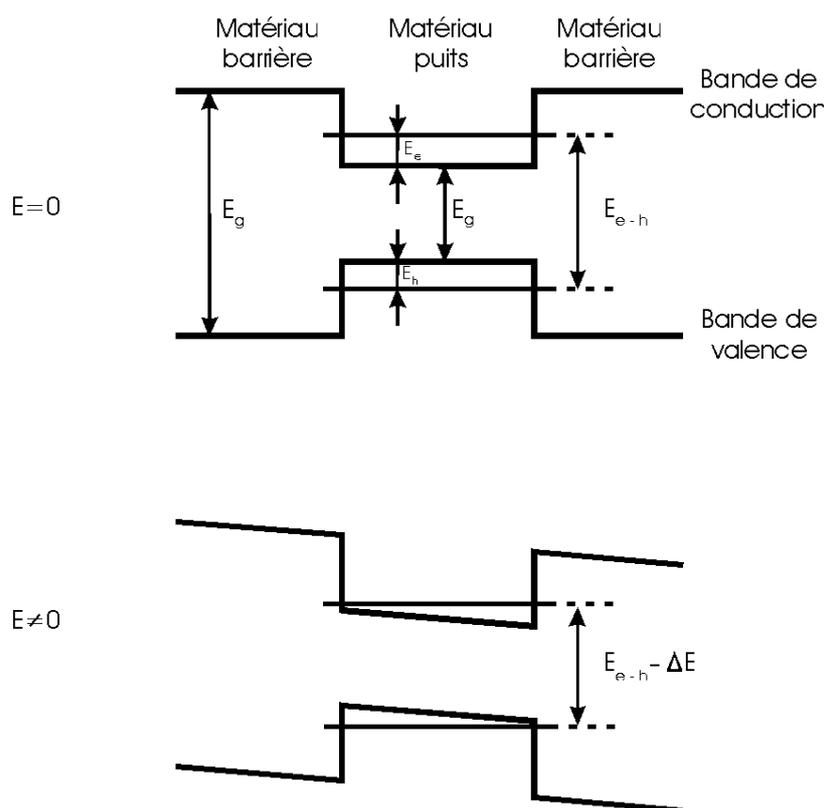
Fig. II-5 : Schéma du diagramme des niveaux d'énergie d'un puits quantique lors de l'application d'un champ électrique  $E$  : l'énergie de transition fondamentale du puits  $E_{e-h}$  est diminuée de  $\Delta E$ .
