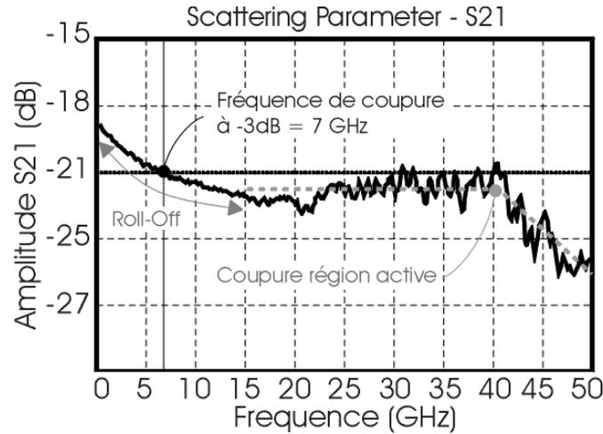
Fig. IV-17 : Observation d'une forte diminution du signal (Roll-Off) pour les basses fréquences (< 5 GHz) sur un modulateur SIBH de  $1.8 \times 100 \mu\text{m}^2$ .
