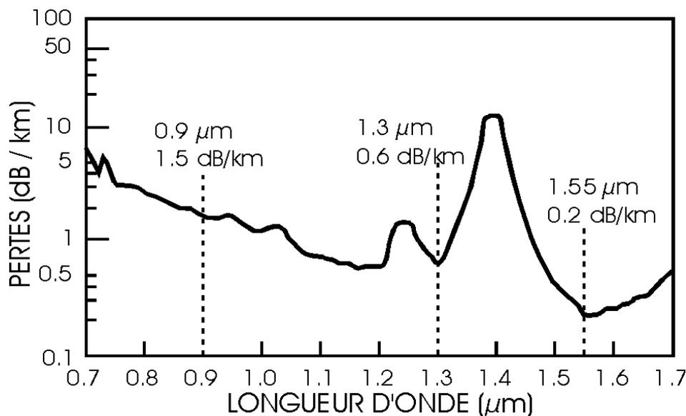
Fig. II-2 : Spectre d'atténuation d'une fibre optique en Silice.
