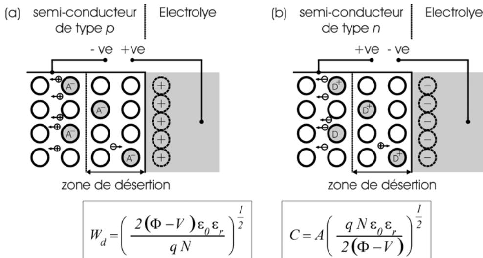
Fig. III-8 : Schéma de la jonction de type Schottky formée entre un électrolyte et un semi-conducteur de type p (a) et de type n (b).
