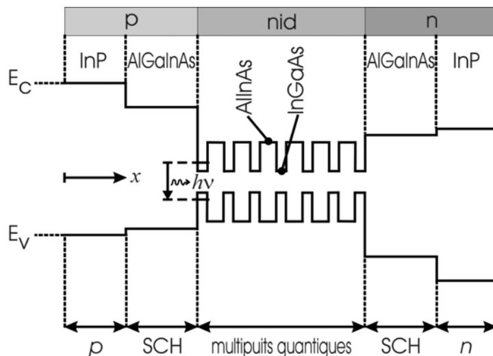
Fig. IV-1 : Schéma de structure de bande d'une structure de modulateur électroabsorbant.
