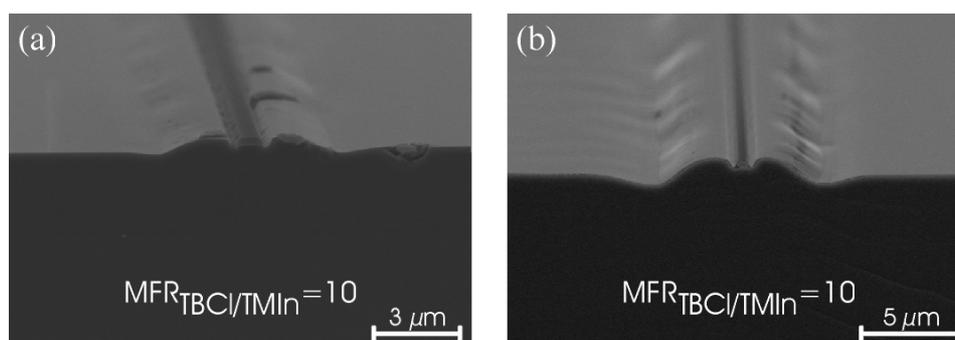
Fig. I-41 : Images MEB de deux reprises effectuées à 700°C – 100mbar avec MFR TBCL/TMIn = 10 sur des rubans respectivement de 3 µm (a) et 5 µm (b) de hauteur.
