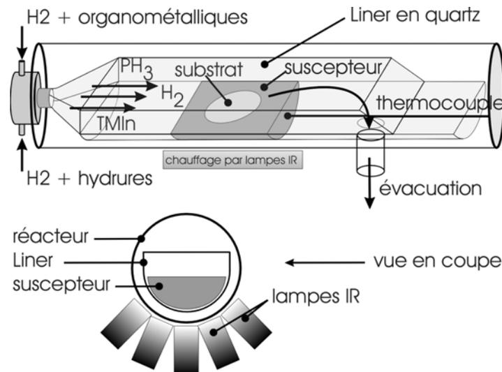
Fig. I-6 : Schéma de principe d'un réacteur MOVPE.
