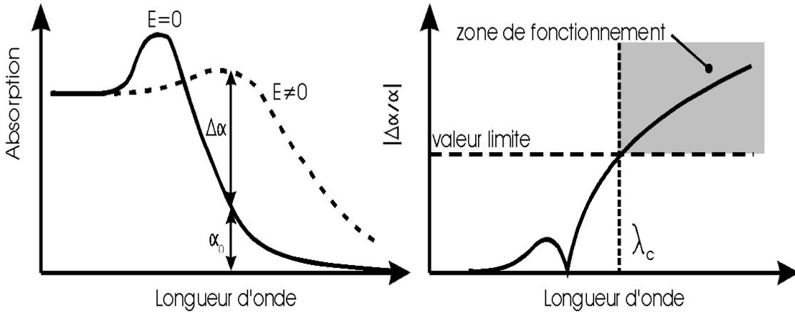
Fig. II-11 : Variation du paramètre  $\Delta\alpha/\alpha_0$  en fonction de la longueur d'onde (à droite) pour un spectre d'électroabsorption d'effet Stark confiné (à gauche). La valeur limite imposée à  $\Delta\alpha/\alpha_0$  définit un domaine en longueur d'onde  $\lambda > \lambda_c$ .
