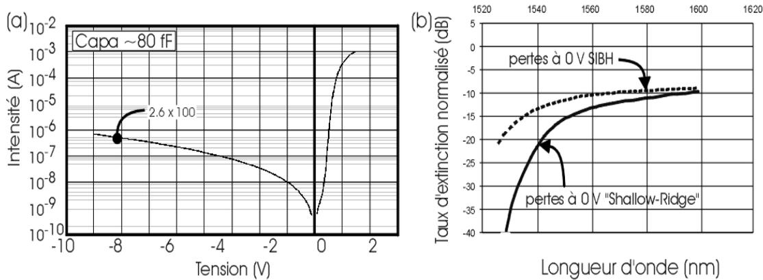
Fig. IV-21 : Mesure de courants de fuite et de capacité (a) pour un modulateur « Shallow-Ridge » de  $2.6 \times 100 \mu\text{m}^2$ . Comparaison des pertes de propagation à 0 V entre un modulateur SIBH de  $1.8 \times 100 \mu\text{m}^2$  et un modulateur « Shallow-Ridge » de  $2.6 \times 50 \mu\text{m}^2$  (b) tous deux à base d'AlGaInAs provenant de la même épitaxie.
