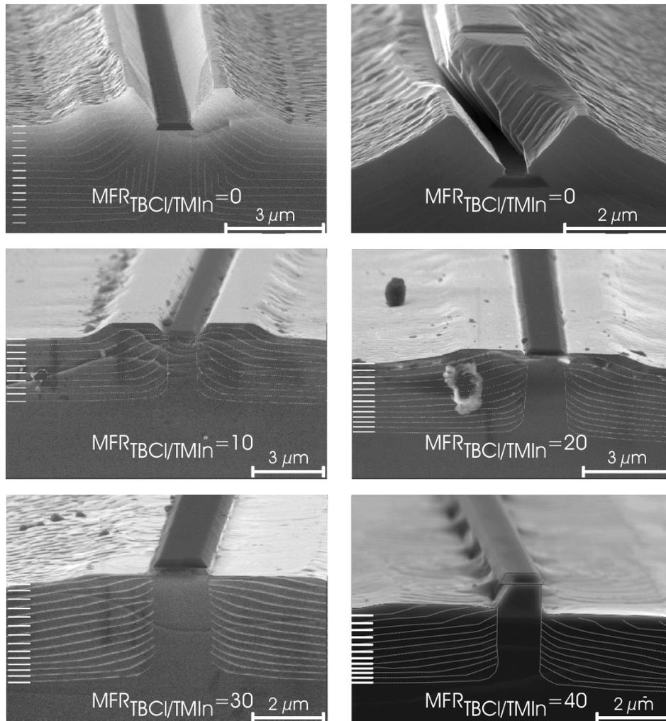
Fig. I-36 : Images MEB d'un ruban de 3  $\mu\text{m}$  de hauteur repris en MOVPE à 635°C – 100 mbar avec adition progressive de TBCL. Les deux images à MRF TBCL/TMIn = 0 proviennent du même échantillon.
