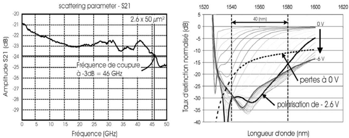
Fig. IV-20 : Mesure de bande passante et de taux d'extinction pour un modulateur « Shallow-Ridge » à base d'AlGaInAs de  $2.6 \times 50 \mu\text{m}^2$ .
