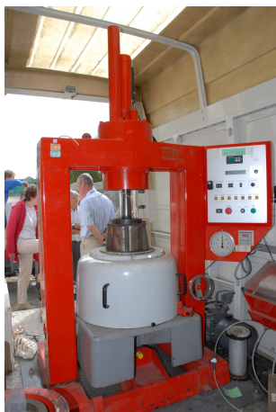
Figure 5.1 : À gauche : presse à cisaillement giratoire installée sur le site nantais du Laboratoire Central des Ponts et Chaussées.
