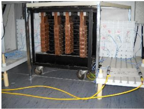
Instrumentation d'un transformateur de laboratoire par un réseau de Fluxgate pour la détermination du flux rémanent
