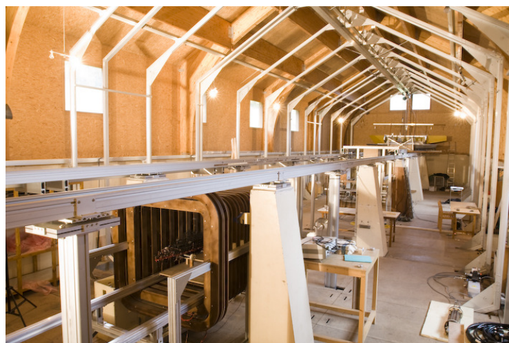
Le simulateur de champ magnétique du LMMCF d'Herbeys. Sur la photo apparaissent les bobines longitudinales, verticales et transverses ainsi que le chemin de roulement.
