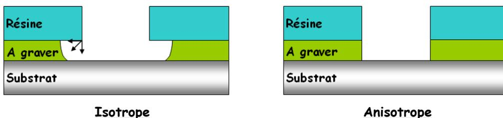
Figure I.33 : Illustration du caractère isotrope/anisotrope
