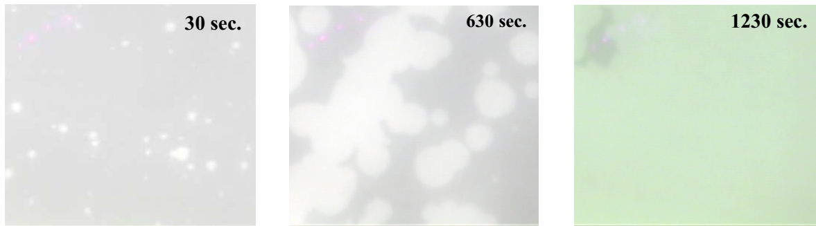
Fig. 3.18 : Images microscopiques (caméra de focalisation du spectromètre Raman) de l'échantillon \text{Ge}_{0,5}\text{Te}_{0,5} prises après 30 s, 630 s et 1230 s à 160°C. Les taches claires correspondent à des zones cristallines alors que les zones sombres correspondent à la phase amorphe.
