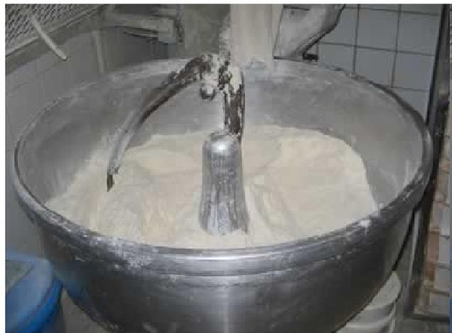
vitesses du frasage et du pétrissage ont un rôle déterminant dans la texturation et la création du réseau de gluten.
