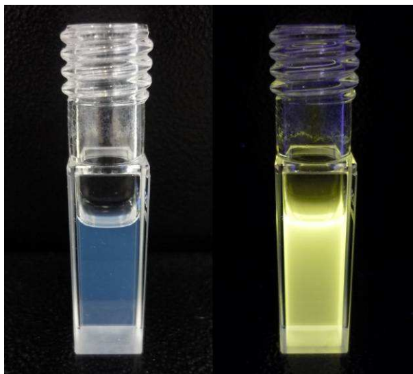
Figure 4.1. Colloïde de ZnO photographié à la lumière du jour (gauche) et sous excitation à 365 nm (droite).
