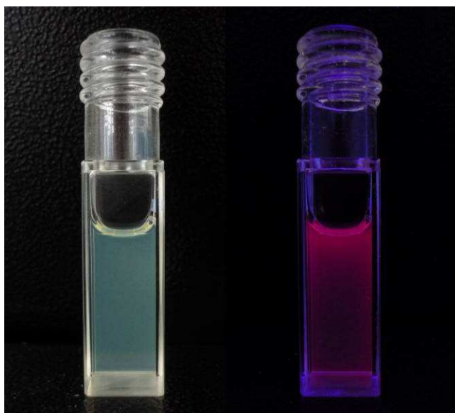
Figure 3.26. Nanoparticules de \text{Cs}_2[\text{Mo}_6\text{Br}_{14}]\text{@SiO}_2 dispersées dans de l'eau, photographiées à la lumière du jour (gauche) et sous irradiation UV à 365 nm (droite).
