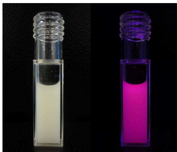
Figure 3.40. Nanoparticules de \text{Cs}_2[\text{Mo}_6\text{Br}_{14}]\text{@SiO}_2 dispersées dans de l'eau (concentration massique \sim 10 g/L), vues à la lumière du jour (gauche) et sous excitation à 365 nm (droite).
