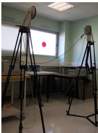
**Figure 3.48** : Mesure d'étalonnage du TPG d'antenne en espace libre
