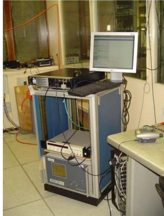
**Figure 4.8 :** Banc d'étalonnage en absolu des récepteurs développé par le CNES
