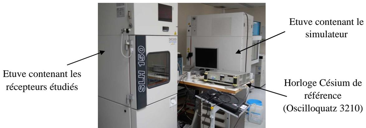
**Figure 3.31** : Montage de l'étude visant à caractériser la sensibilité thermique et hygrométrique des équipements
