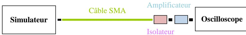
Figure 3.19 : Eléments de la chaîne RF utilisés lors de l'étalonnage du simulateur
