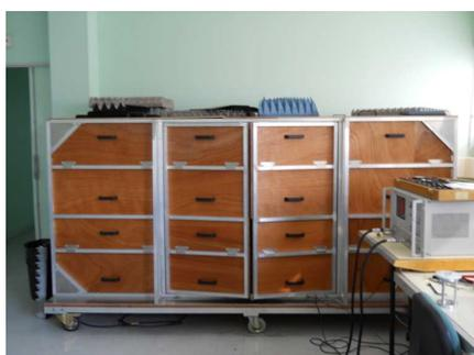
**Figure 4.10** : Banc d'étalonnage en absolu des antennes développé par le CNES
