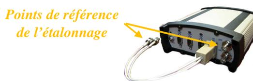
**Figure 2.6 :** Points de référence de l'étalonnage du récepteur Novatel Propak-V3
