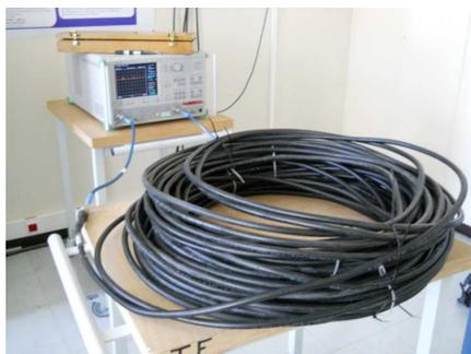
**Figure 5.20 :** Etalonnage du câble d'antenne de la chaîne de réception GPS de la PTF italienne
