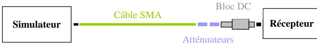
Figure 3.18 : Eléments de la chaîne RF utilisés lors de l'étalonnage du récepteur
