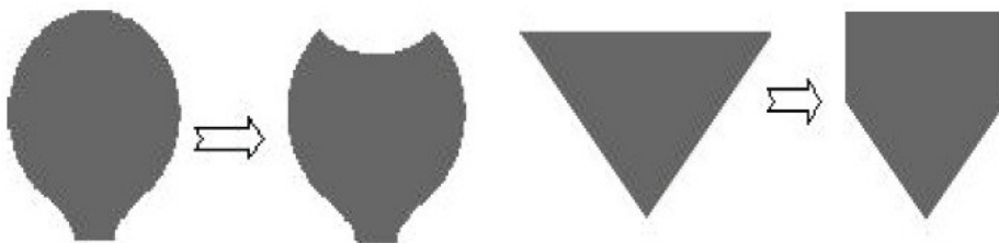
Figure 1.39: Illustration d'exemple de structure rayonnante ayant un périmètre constant pour des géométries différentes
