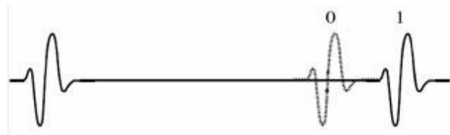
Figure 1.19: Illustration de bits "0" et "1" avec une modulation PPM
