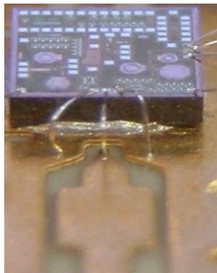
Figure 3.41: La puce et les "wirebonds" réalisés
