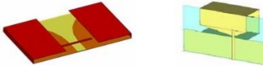
Figure 1.46 Repliement volumique du plan de masse et de l'élément rayonnant
