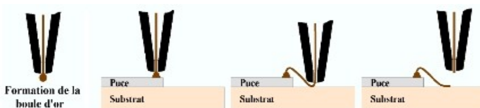
Figure 3.3: Illustration des différentes étapes de la technique "ball bounding"
