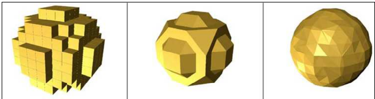
Figure II.3 Comparaison d'interfaces fluide/solide réalisées par voxelisation, maillage Simplified Marching Cube puis Marching Cube [COI03]
