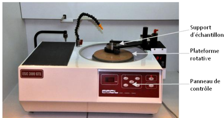
Figure 2.1. Polisseuse mécanique permettant de préparer les échantillons.
