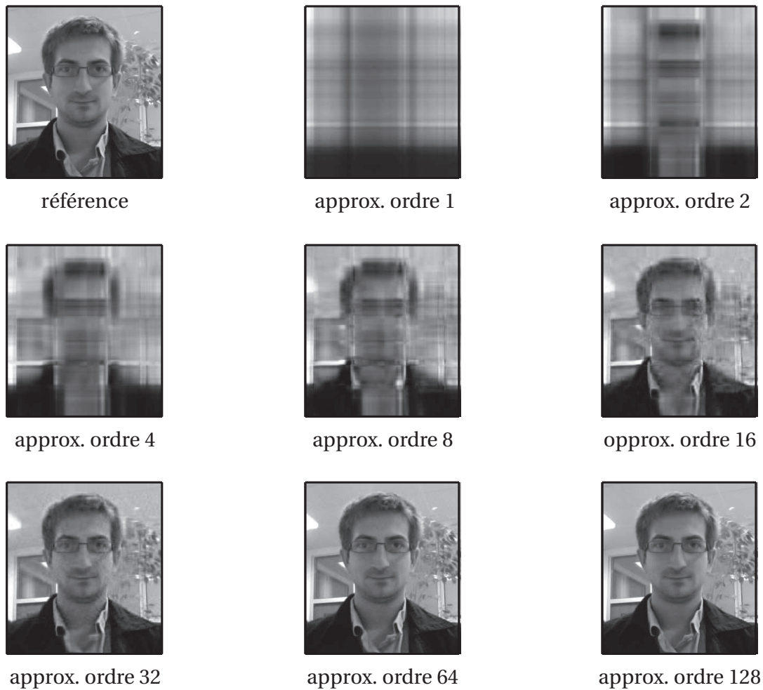
FIGURE 3.4 : POD tronquées d'une image de 330 \times 297 pixels
