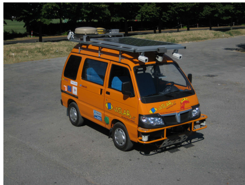
FIGURE 1.3 – Un des véhicules Overland qui a réalisé 13000km en totale autonomie
