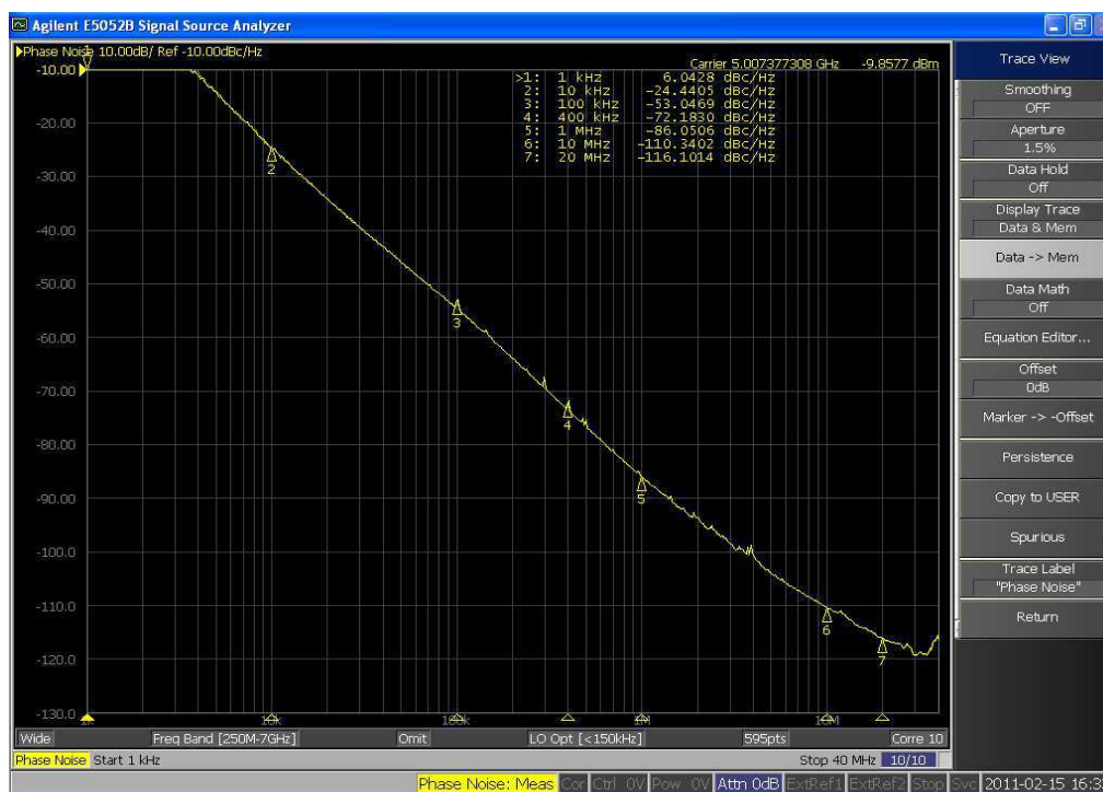
Figure 7-9 : Le bruit de phase dans les oscillateurs OSC_2T_2B
