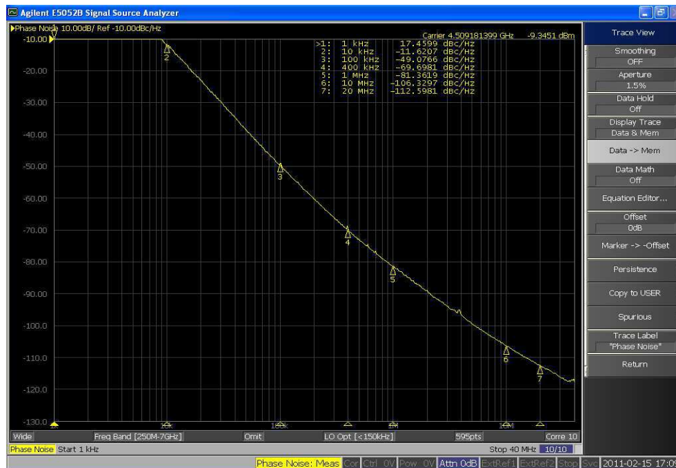
Figure 7-11 : Le bruit de phase dans l'oscillateur OSC_2T_3B_DYN
