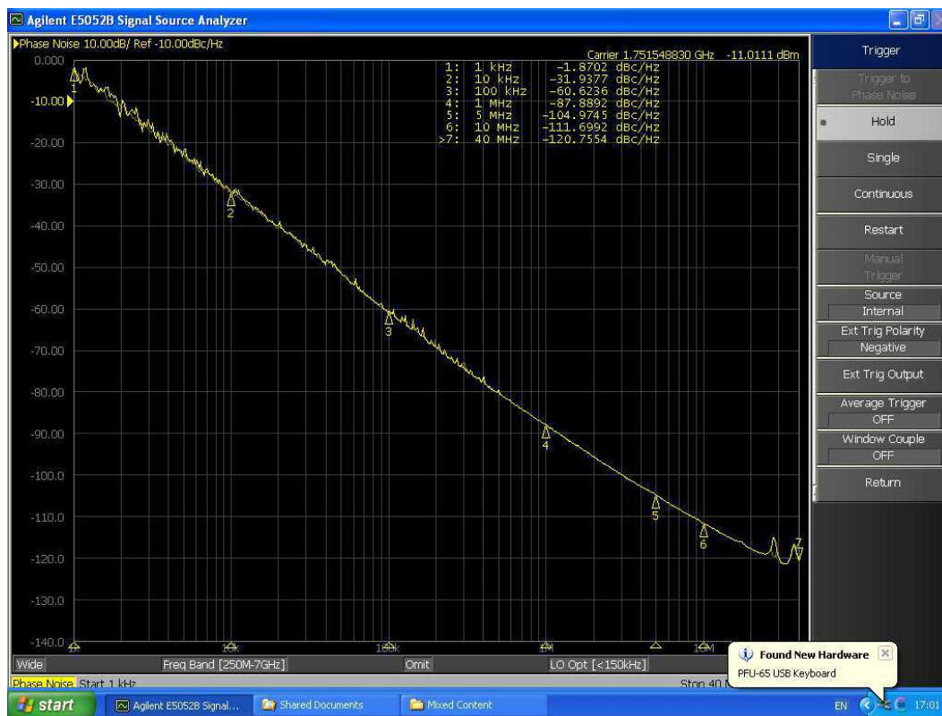
Figure 7-14 : Le bruit de phase dans l'oscillateur OSC_21_INV
